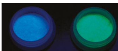
Figura 18. 2-(4'-amino-2'-hidroxifenil)benzotiazol sob radiação UV que emite na região do azul quando em matriz polar (ortosilicato de tetraetila) e na região do verde quando em matriz menos polar (ortosilicato de tetraetila 1:1 dimetildimetoxisilano). 175
