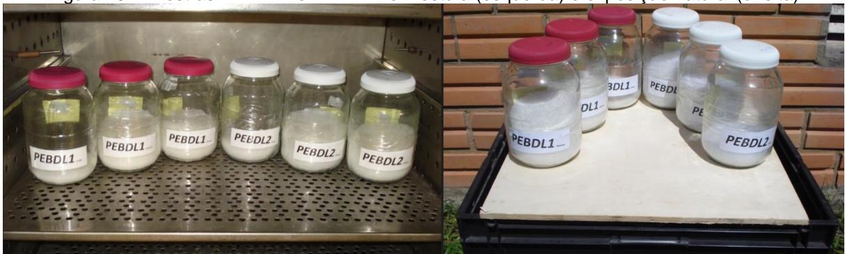
Figura 13: Amostras PELBD1 e PELBD2 em estufa (esquerda) e exposição natural (direita)
