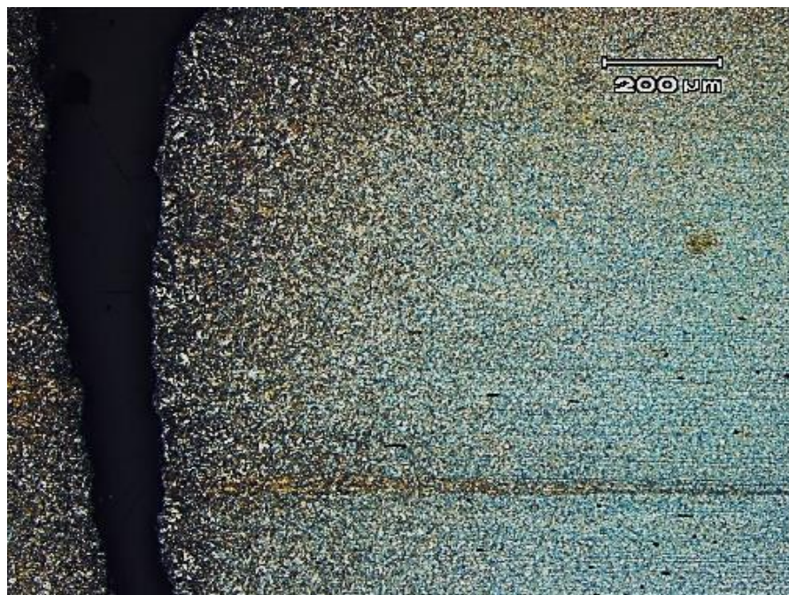
Figura 41 – Local de Início da Nucleação da Trinca de uma Amostra B em Maior Aumento.
