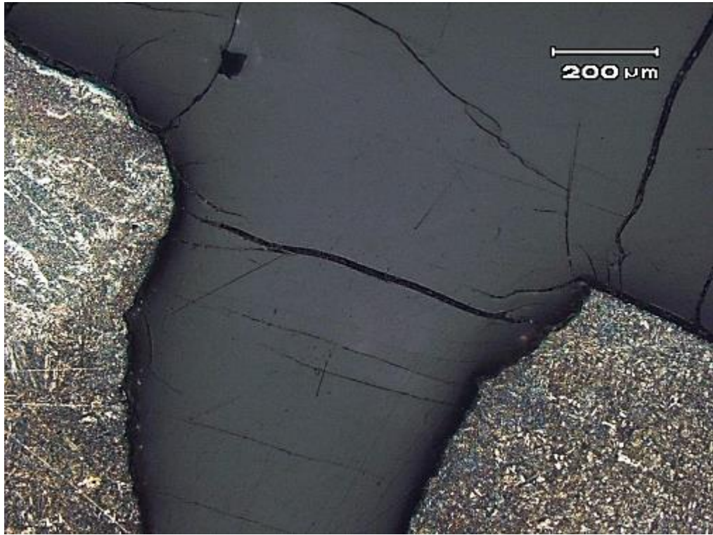
Figura 20: Região 9. Início da propagação da trinca em maior aumento.
