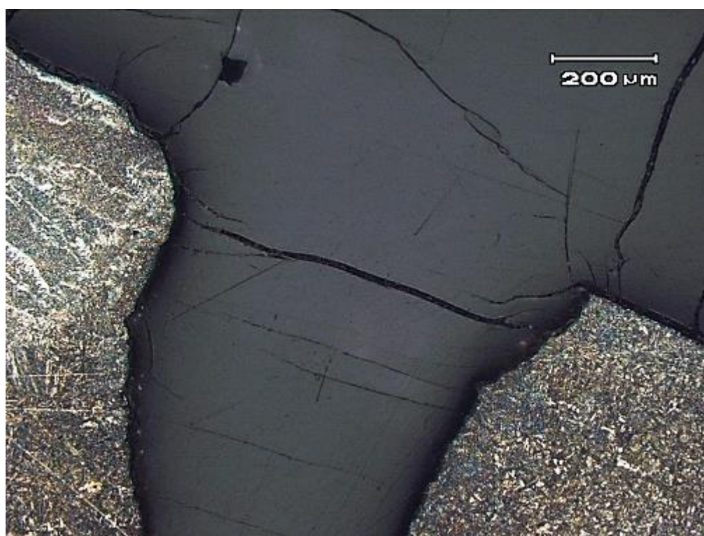
Figura 39 – Local de Início da Nucleação da Trinca de uma Amostra A em Maior Aumento.
