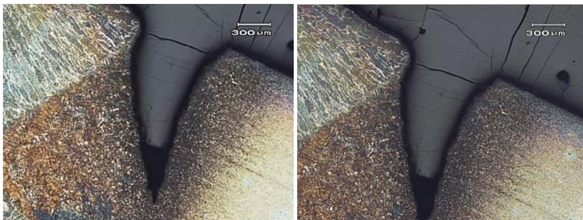
Figura 38 – Local de Início da Nucleação da Trinca de uma Amostra A.
