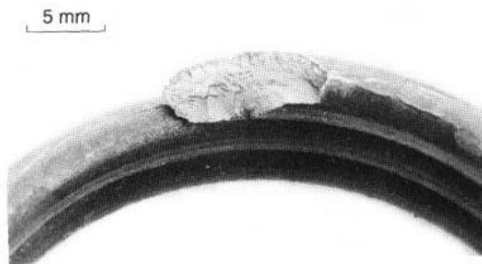
Figura 9. Fratura de uma mola por fadiga [27].
