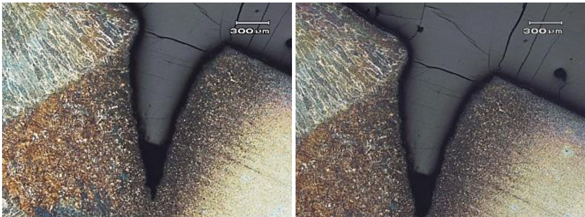
Figura 20: Região 9. Início da propagação da trinca.
