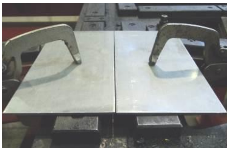
Figura 17. Placas fixadas no dispositivo de solda.
