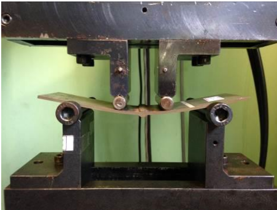
Figura 25. Dispositivo de fixação das amostras para ensaio de fadiga.
