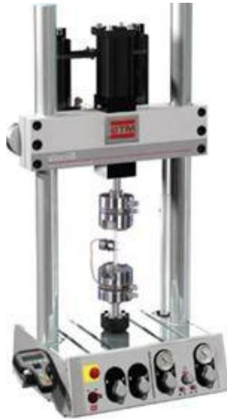
Figura 24. Equipamento Servo Hidráulico usado no ensaio de fadiga.
