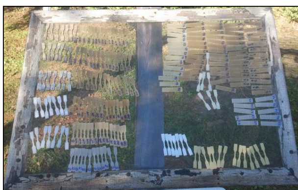
Figura 20 – Suporte utilizado para o ensaio de degradação abiótica com as amostras de PP e suas blendas
