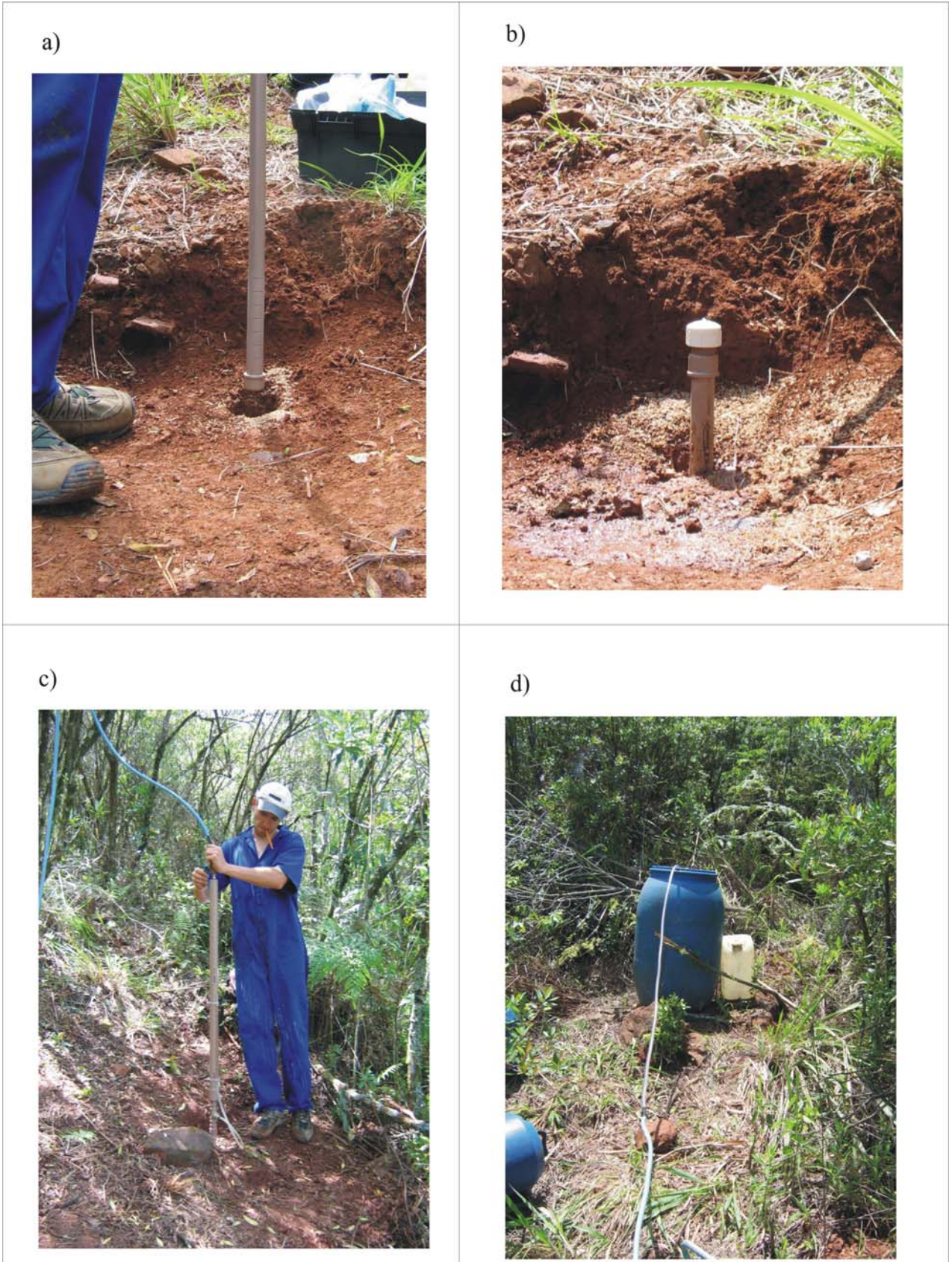
Figura 4.6: Piezômetro. a) tubo de água sendo introduzido no furo; b) tubo de água instalado; c) execução das leituras e d) reservatório de água
