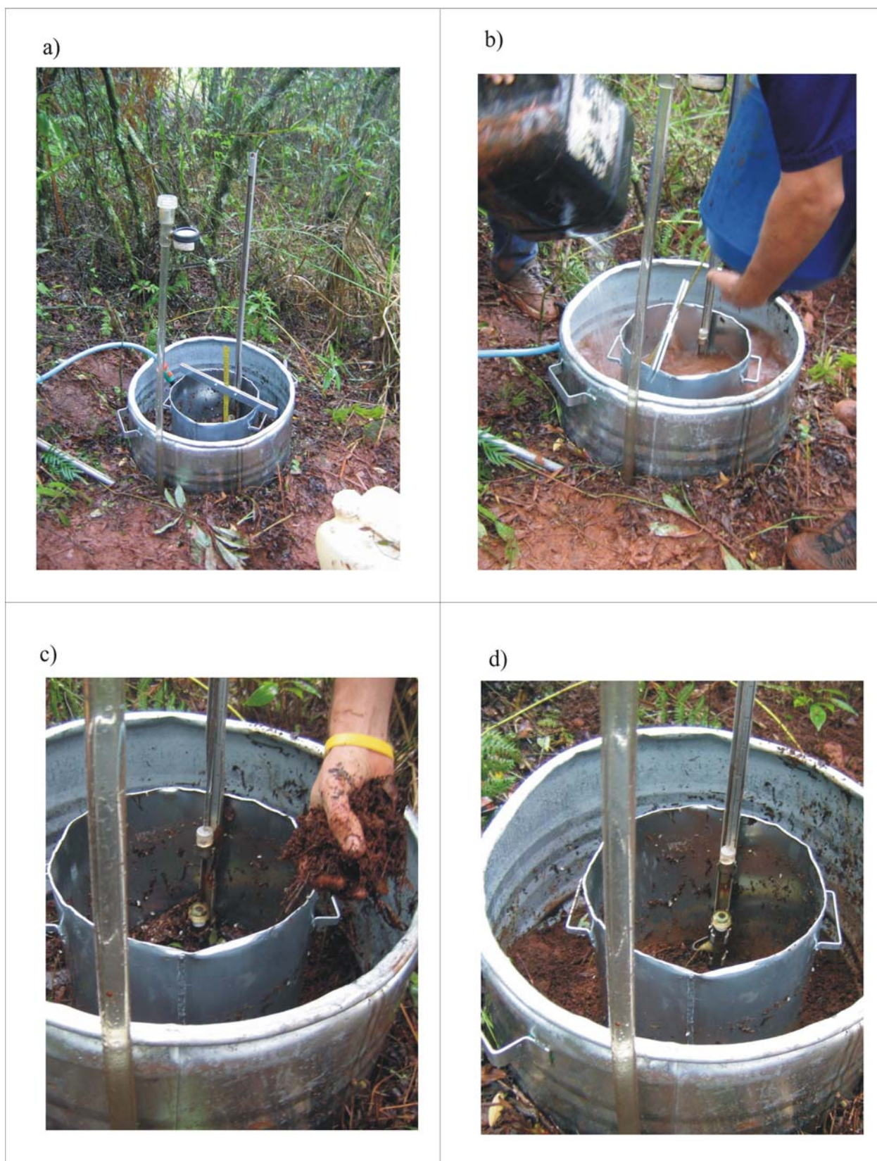
Figura 4.7: a) Infiltrômetro de anel duplo instalado; b) preenchimento dos anéis com água; c) remoção da “serrapilheira” e d) ”serrapilheira” removida
