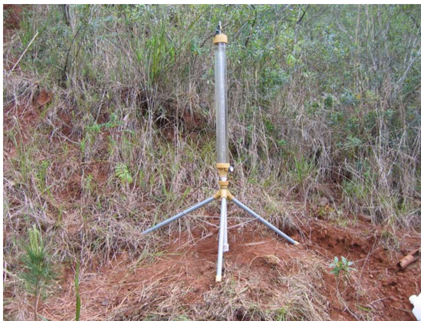
Figura 4.4: Permeâmetro de Guelph instalado, ensaio cota 350 m
