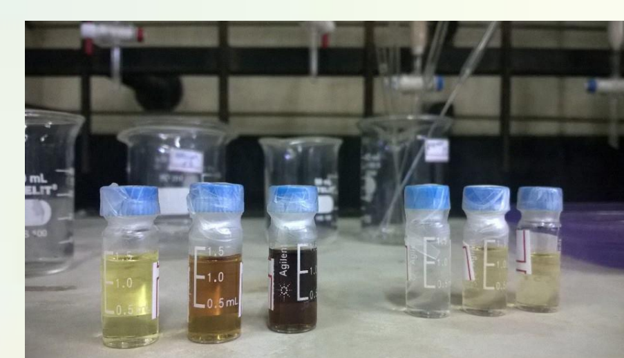
Preparação das amostras de alcatrão (1000 mg L -1 ) e 17 soluções de padrões de CS e CN
