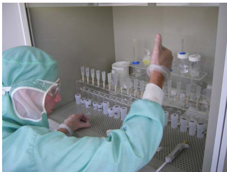
FOTO 1.4 – Procedimento de separação de zinco em microcolunas.
