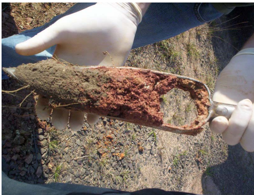
FOTO 1.2 – Contato entre materiais de aterro (vermelhos) e sedimentos quaternários (marrom).
