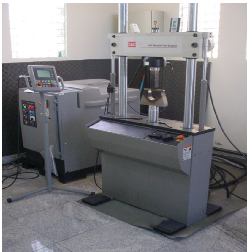
Figura 27 - Máquina MTS modelo 810, já com o dispositivo posicionado.
