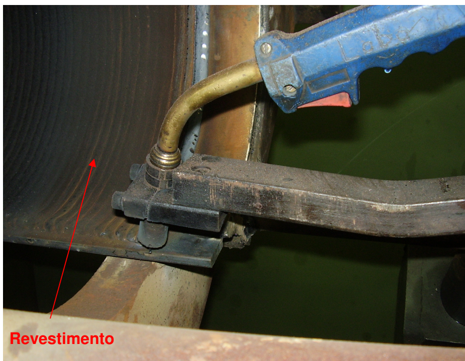
Figura 21 - Tubo com o revestimento (perspectiva em corte).
