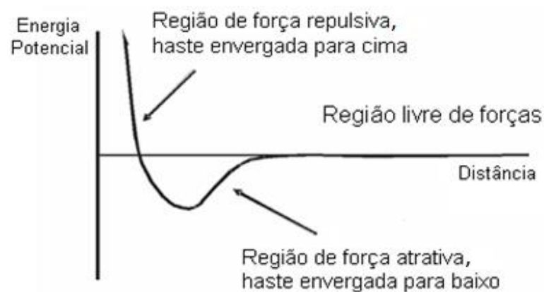
Figura 2: Gráfico da energia potencial versus distância entre ponta e amostra mostrando as regiões de atuação do AFM.
