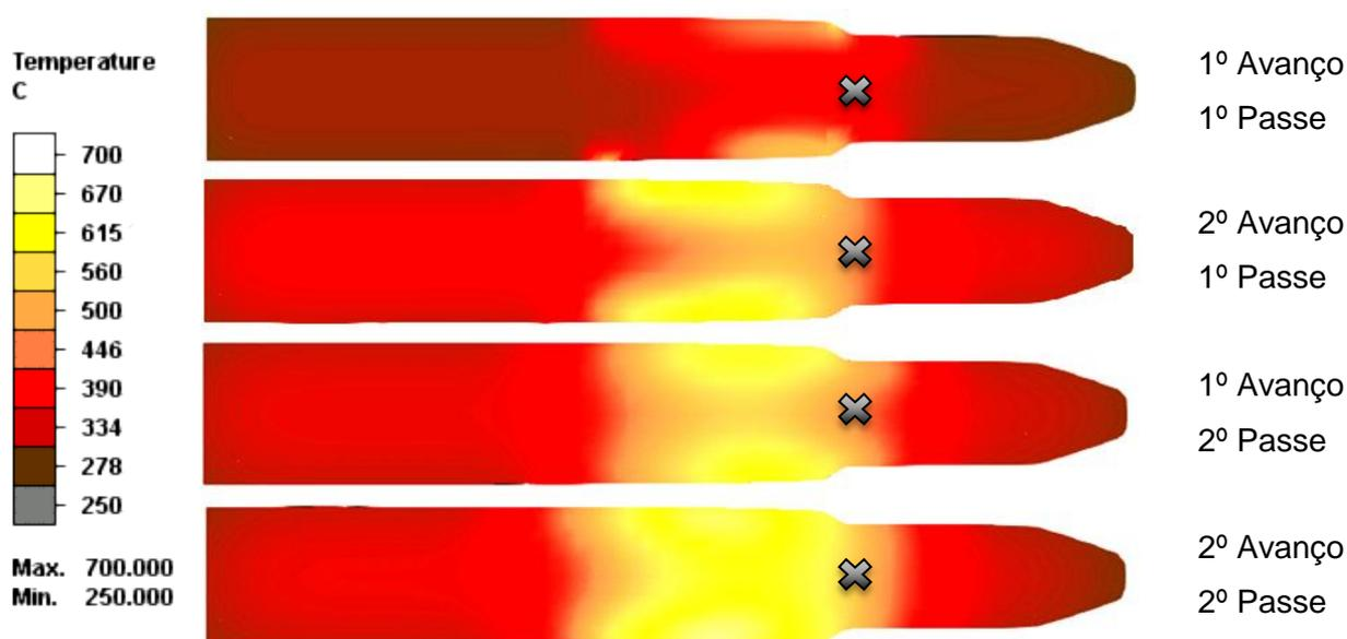
Figura 71 – Temperaturas na simulação nos mesmos momentos em que foram medidos no experimento pelo termopar.
