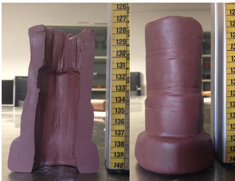
Figura 53 – Geometria final do ensaio com plasticina utilizando o mandril de 60°.
