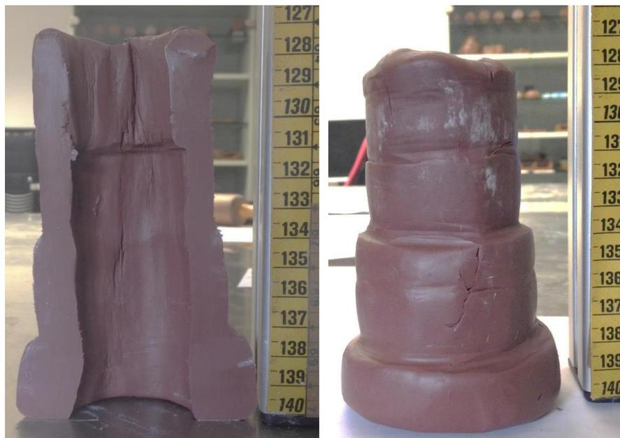
Figura 52 – Geometria final do ensaio com plasticina utilizando o mandril de 30°.
