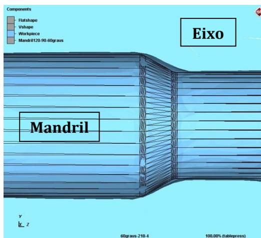
Figura 48 - Região de transição com o contorno do mandril em evidência.
