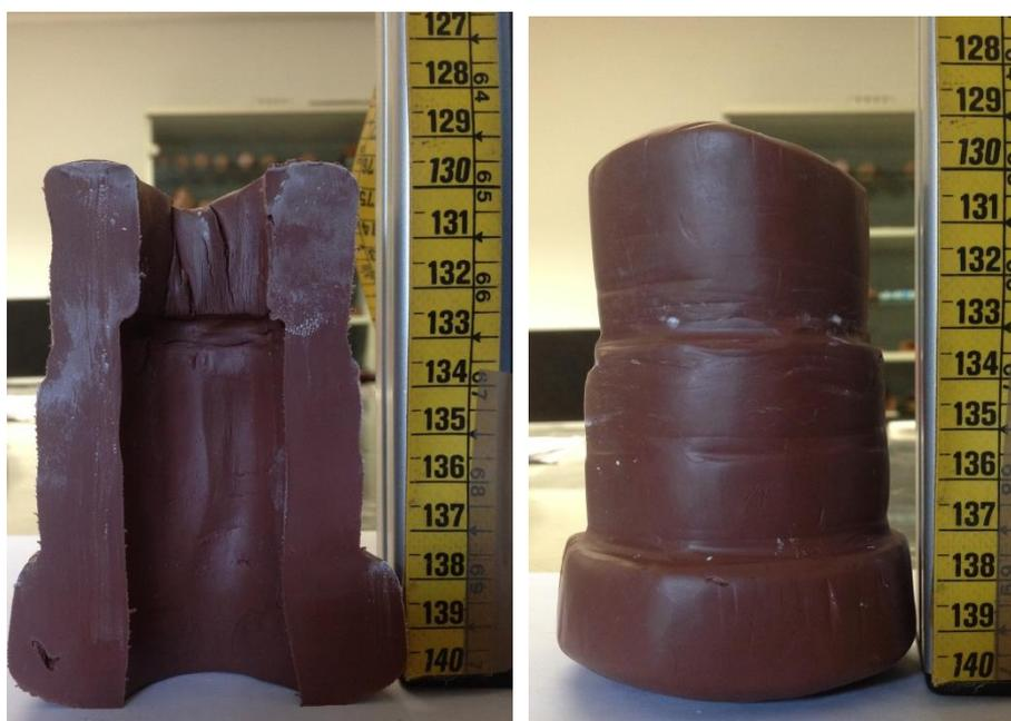
Figura 51 – Geometria final do ensaio com plasticina utilizando o mandril de 0°.
