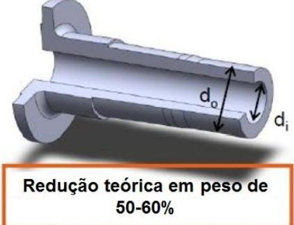
Figura 5 – Aumento da resistência mecânica e redução de peso em eixos forjados e vazados [Adaptado de Recker, 2013].
