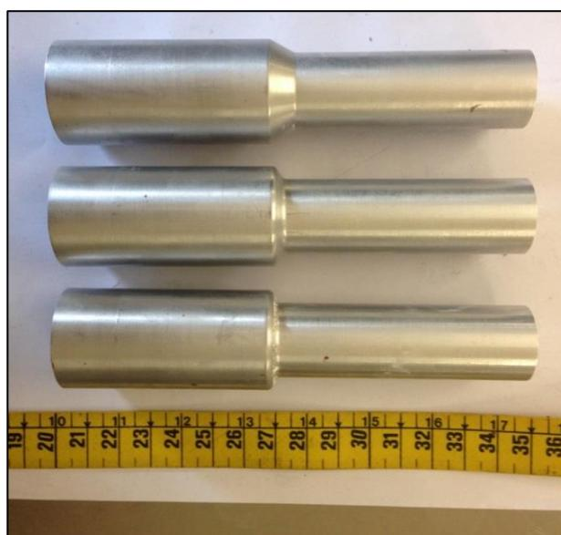
Figura 37 – Mandris em escala utilizados nos ensaios com plasticina.
