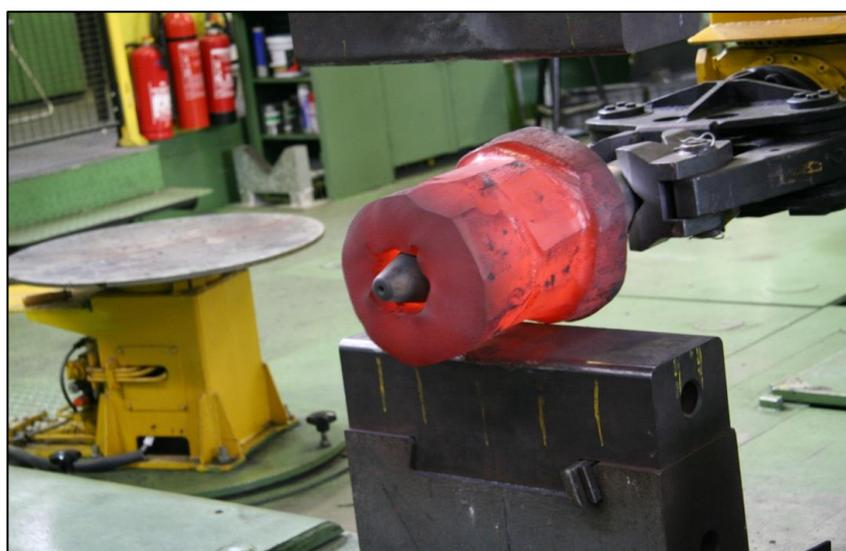
Figura 63 – Forjamento após o segundo passe do processo.
