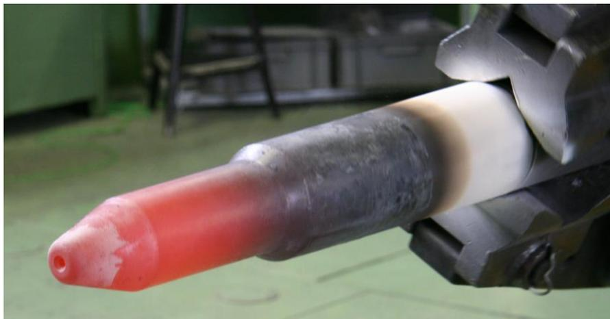
Figura 74 – Mandril após retirada do eixo forjado após último passe de forjamento.
