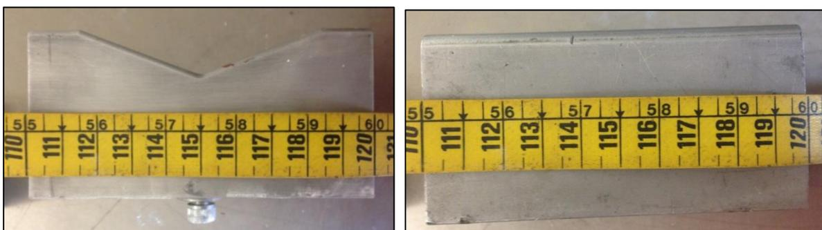
Figura 38 – Matrizes utilizadas nos ensaios com plasticina.
