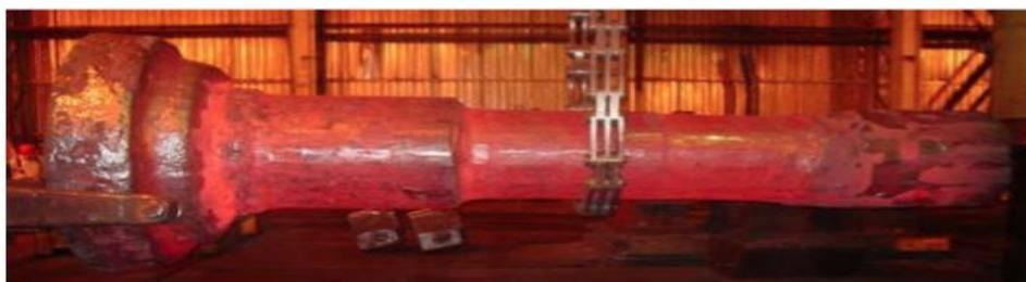
Figura 4 – Eixo maciço forjado de 8 toneladas para aerogerador [Fonte: Villares Metals, 2011].
