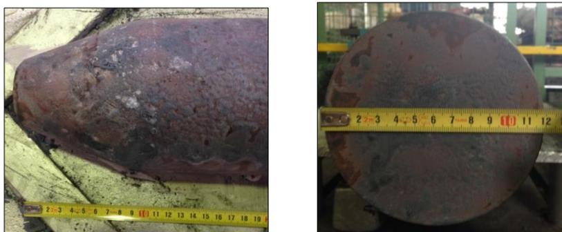
Figura 60 – Mandril utilizado para confecção do mandril projetado.
