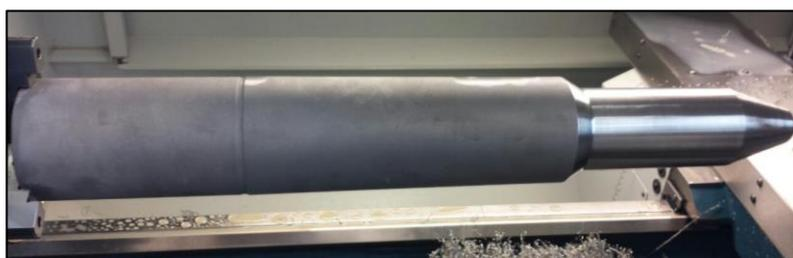
Figura 61 – Forma final do mandril a ser utilizado.
