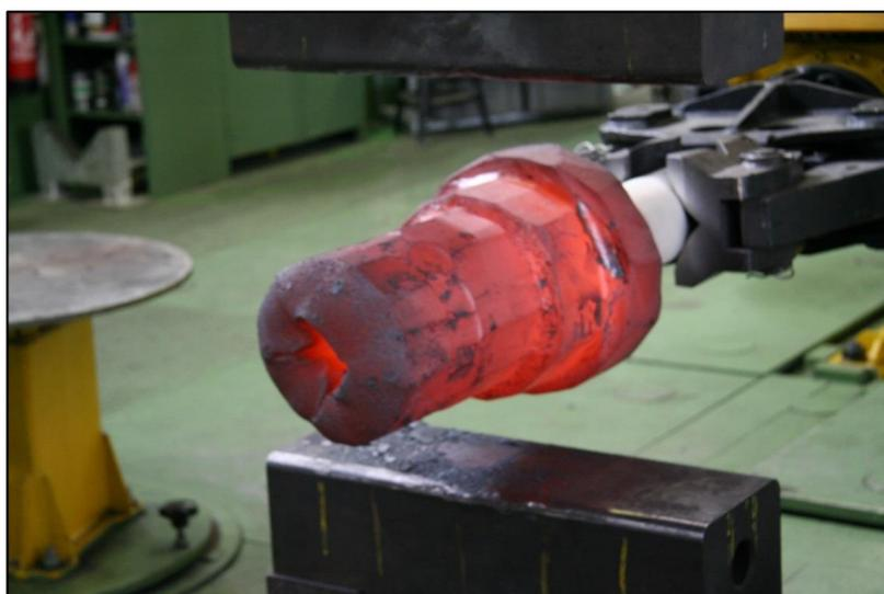
Figura 73 – Geometria da peça após o forjamento.
