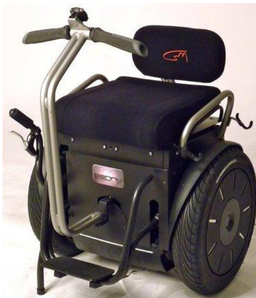
Figura 2.6 - Cadeira de rodas com o uso do sistema "Segway©" [Ggpht, 2011].
