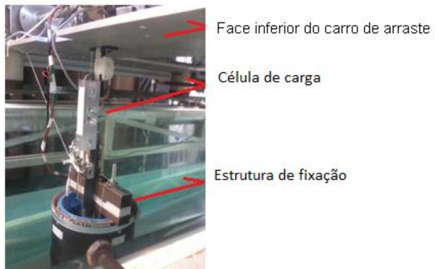
Figura 8.3 Sistema de fixação do cilindro no carro de arraste.
