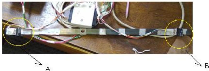
Figura 8.10 Acelerômetros; (A) junto ao carro de arraste, (B) interno ao cilindro.
