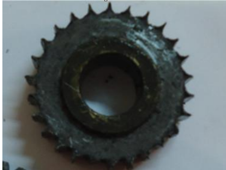
Figura 36: Roda dentada desgastada utilizada na caixa de transmissão para simular modo de falha 3.
