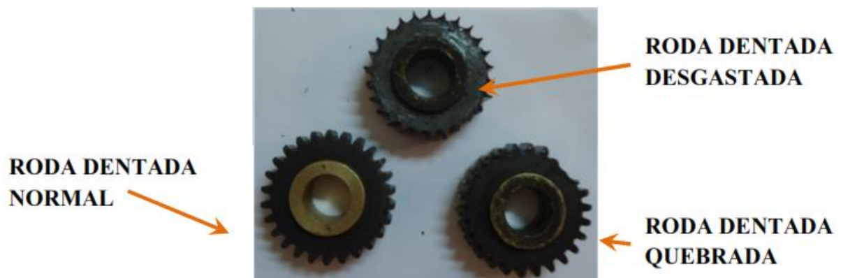
Figura 31: Conjunto de rodas dentadas aplicado para simulação das falhas.
