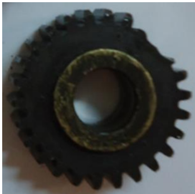
Figura 39: Roda dentada danificada utilizada na operação em modo de falha 5.
