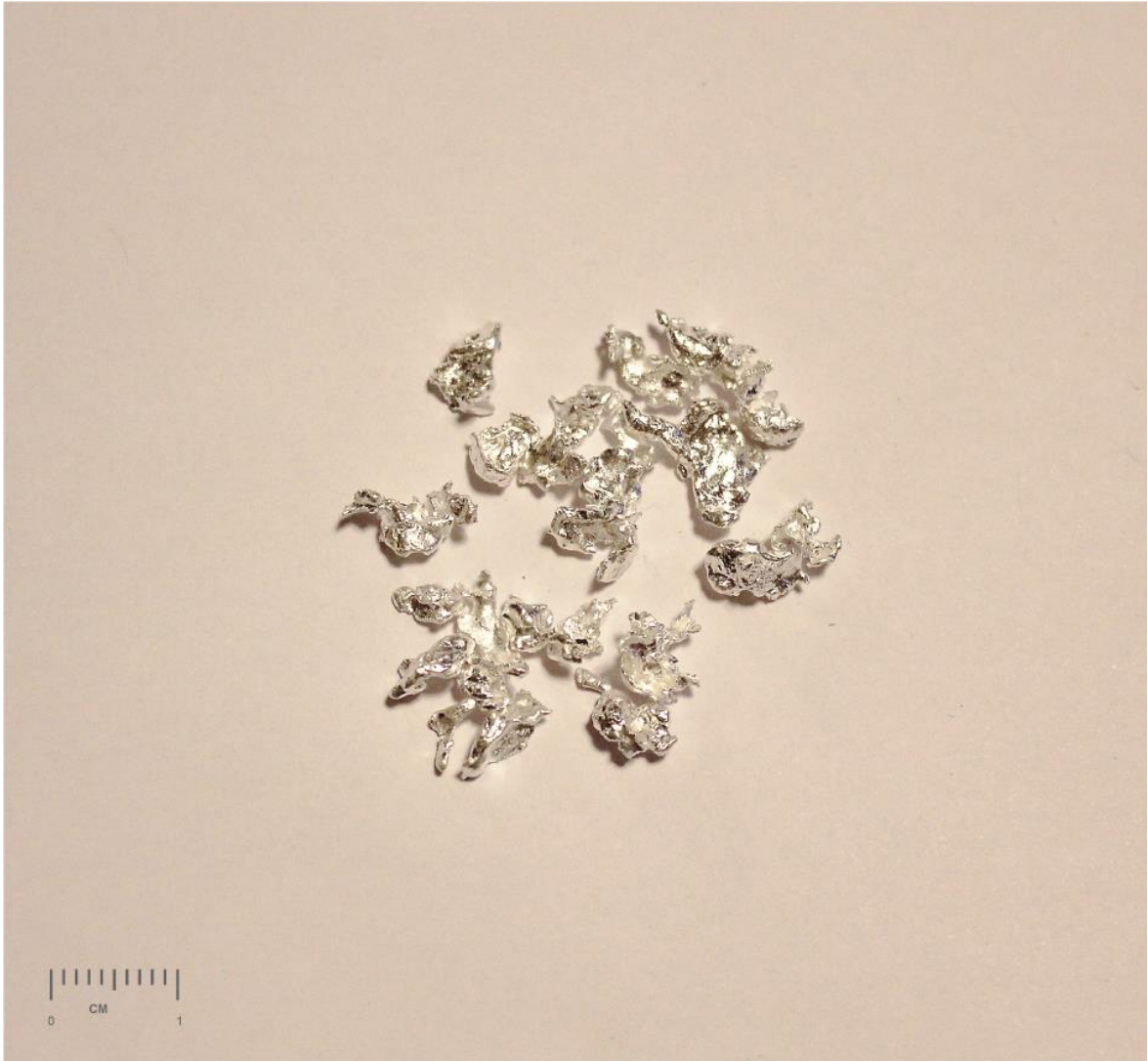
Figura 35 - Detalhe da prata recuperada das radiografias
