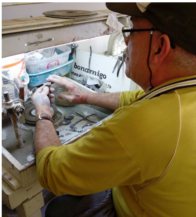
Figura 37 – Processo de lapidação manual realizado pelo lapidador
