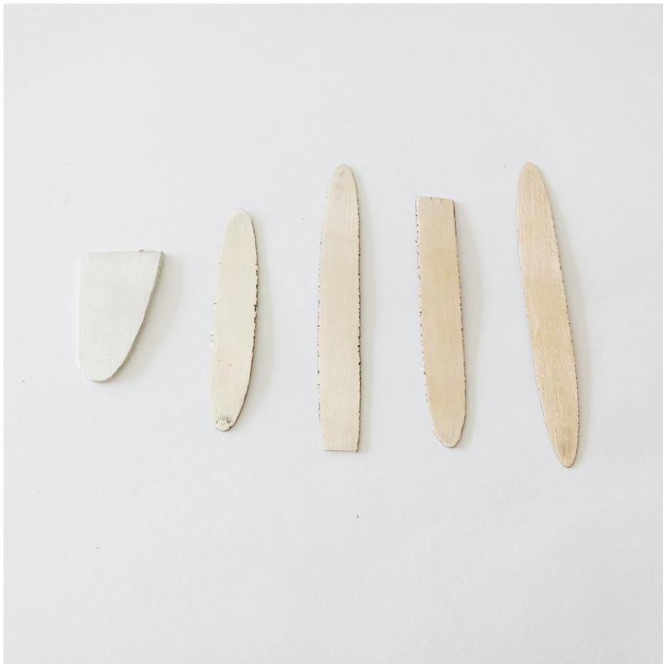
Figura 45 - Testes de liga variando a proporção de Cu e Ag.
