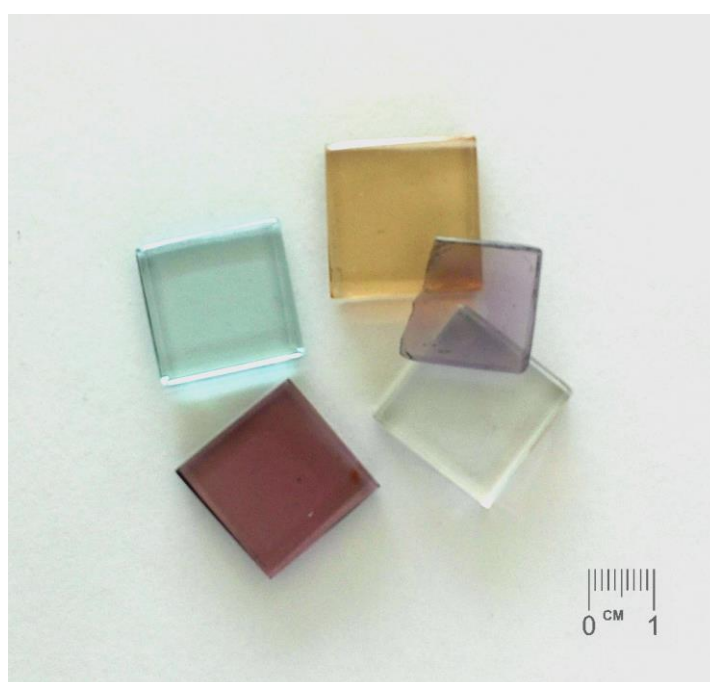
Figura 46 - Vidros selecionados e lapidados para analisar o índice de refração da luz
