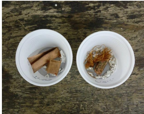
Figura 49 – Liga tradicional e recuperada respectivamente, antes da fundição
