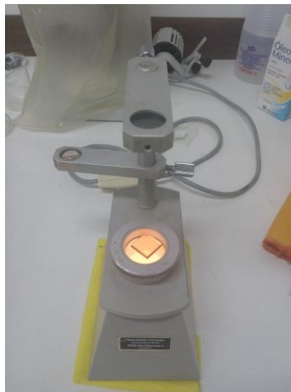
Figura 58 - Análise do vidro no polariscópio
