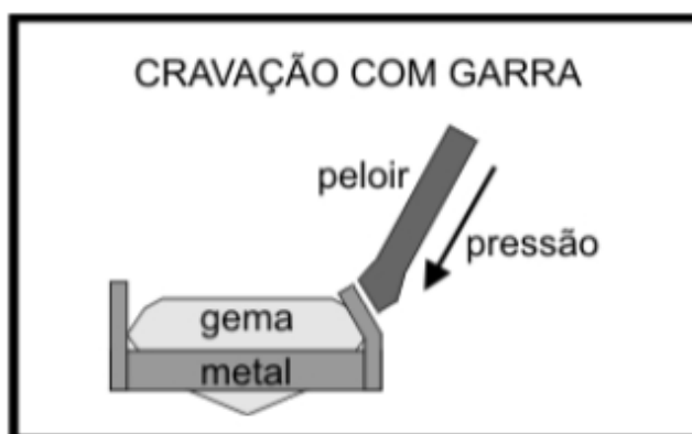
Figura 20 - Processo de cravação de gemas
