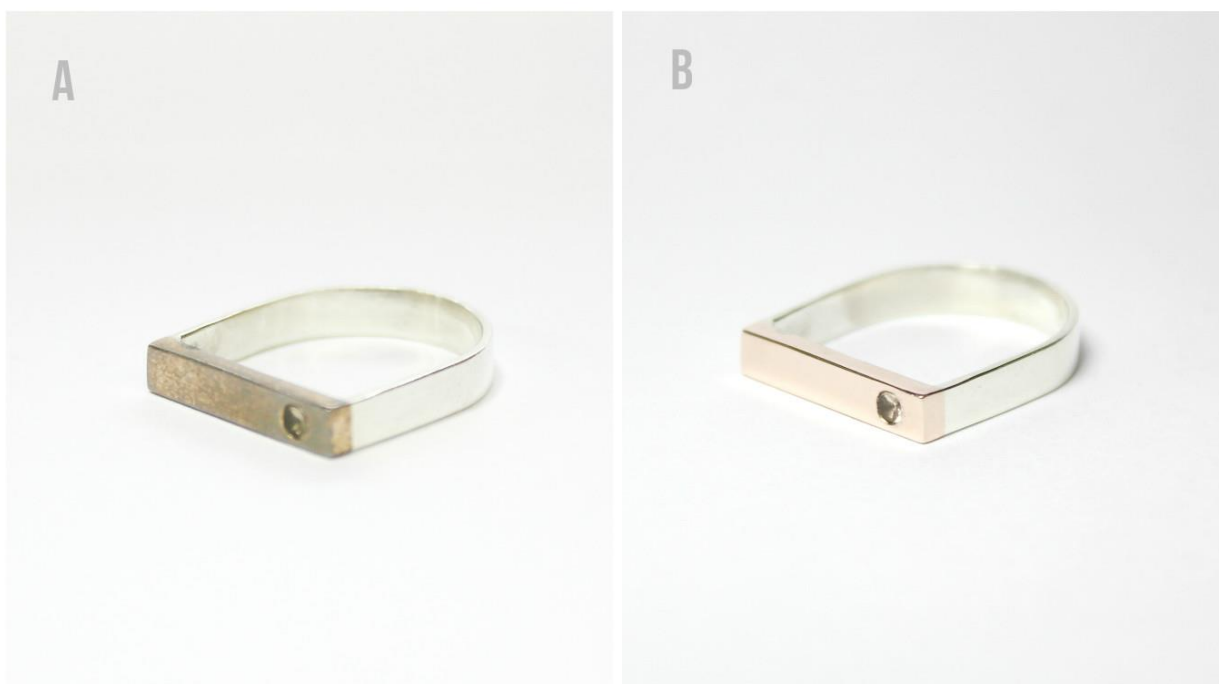
Figura 68 - Peça escurecida com a oxidação (esquerda) e com o tom rosado após polida (direita)
