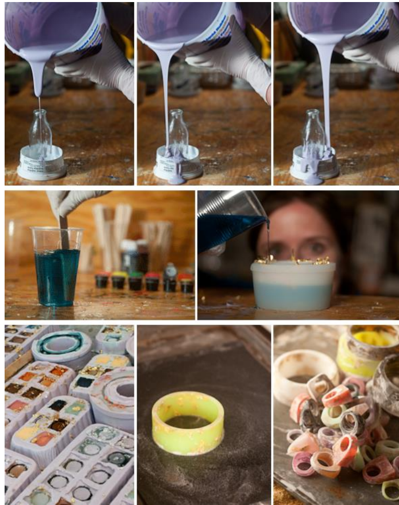
Figura 40 - Processo de fabricação da Rosella Resin Jewelry
