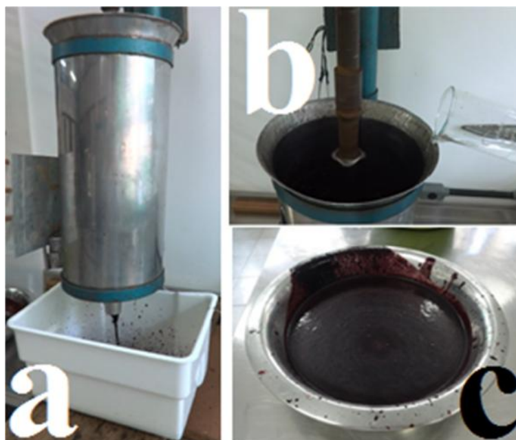
Figura 6 - Despolpadeira Vertical (a); Adição de água com proveta (b); Refresco obtido (c)
