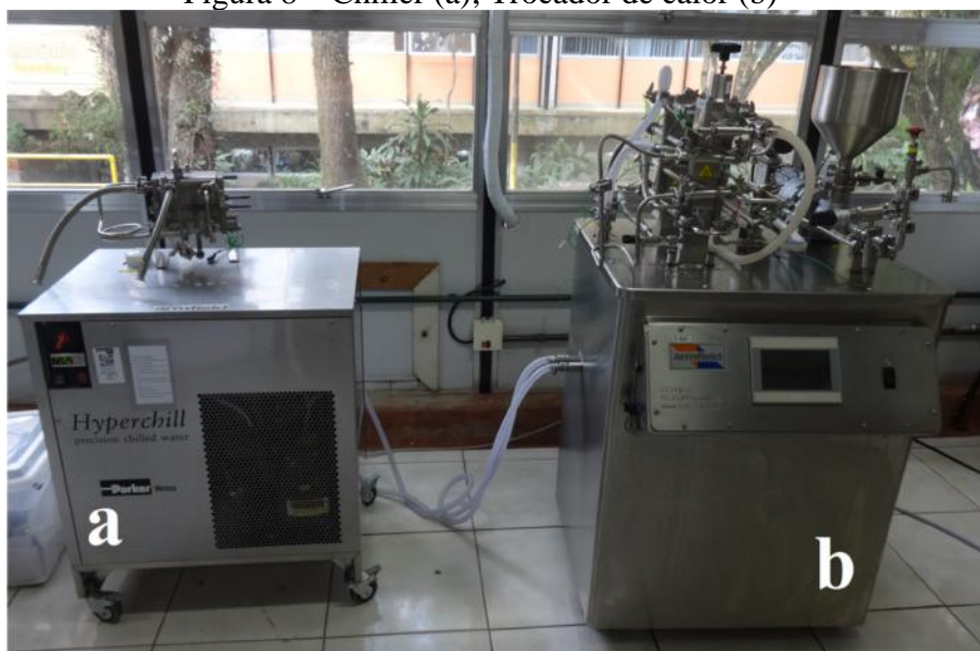
Figura 8 – Chiller (a); Trocador de calor (b)
