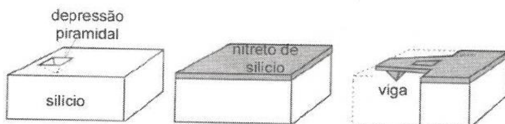
Figura 31: Fabricação de sondas e vigas para o AFM (Veeco)
