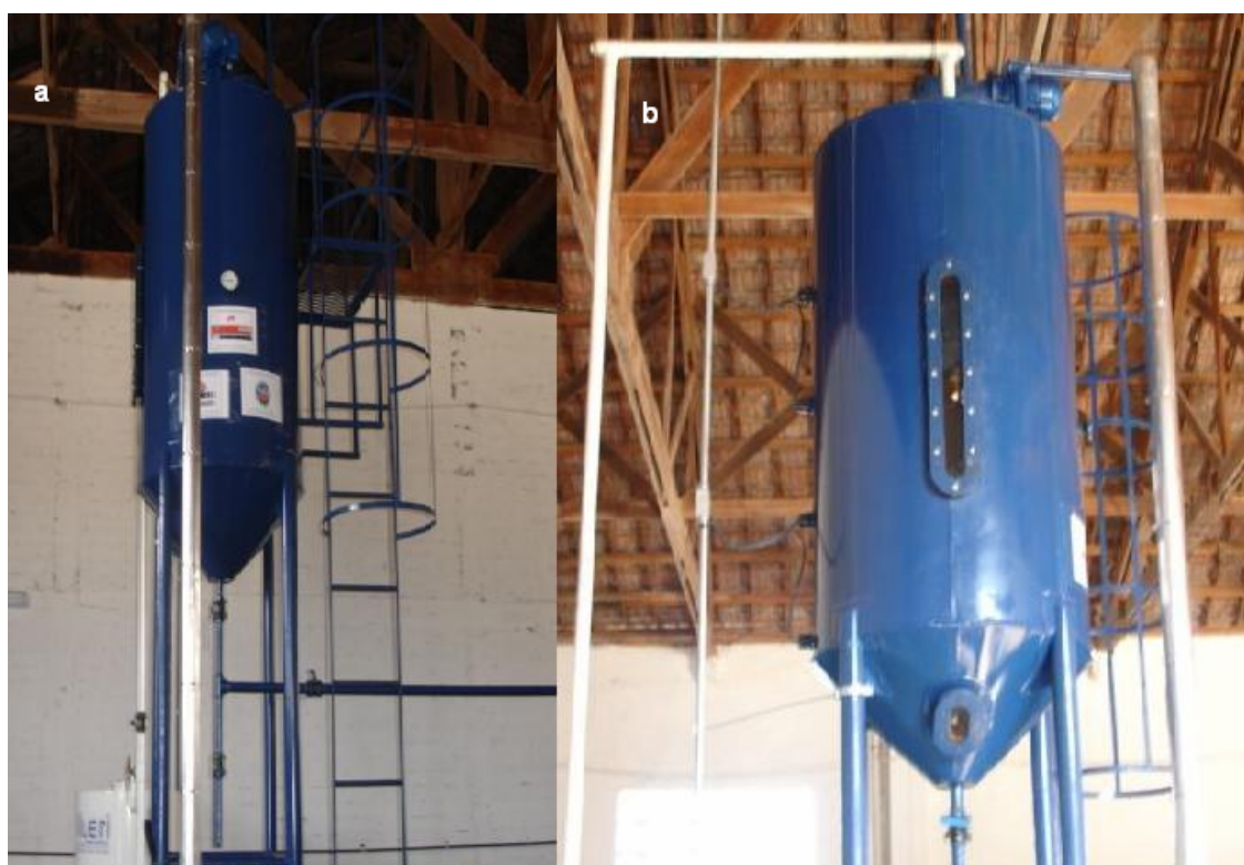
Figura 2. Fotografias do reator da usina-piloto de biodiesel: (a) visão geral do reator/decantador; (b) detalhe dos visores do reator
