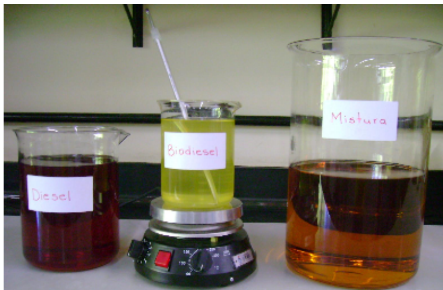
Figura 3. Fotografia das amostras de biodiesel de sebo bovino, diesel metropolitano e de uma mistura diesel/biodiesel.
