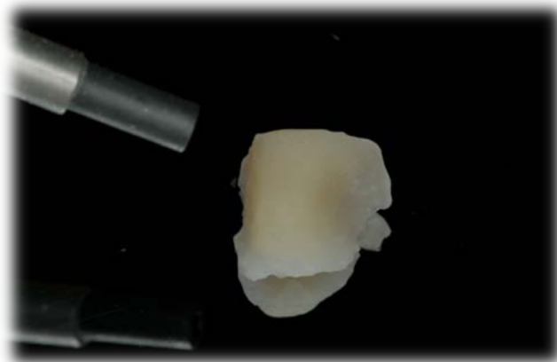
Figura 26: Jateamento da peça com óxido de alumínio.
