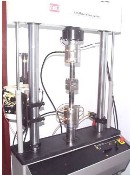
Figura 25 - A imagem mostra o dispositivo montado para o teste de fadiga no sistema para testes de materiais.
