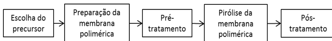
Figura 2.3 - Etapas para a produção de uma membrana de carbono.
