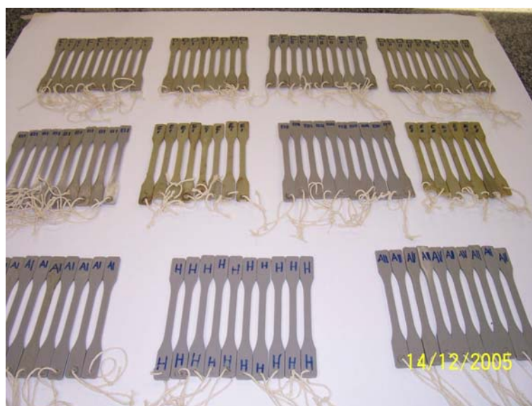
Figura 19 – Corpos-de-prova para ensaio de fotodegradação por radiação UV.
