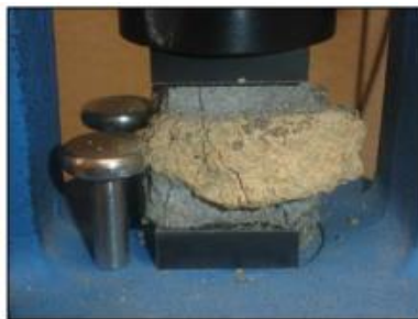
Figura 44 – momento de ruptura da amostra ensaiada
