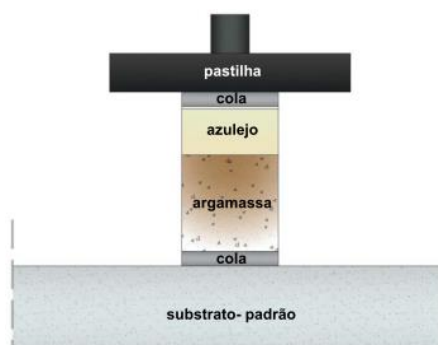
Figura 82 – representação da configuração do corpo de prova para o ensaio da resistência de aderência à tração
