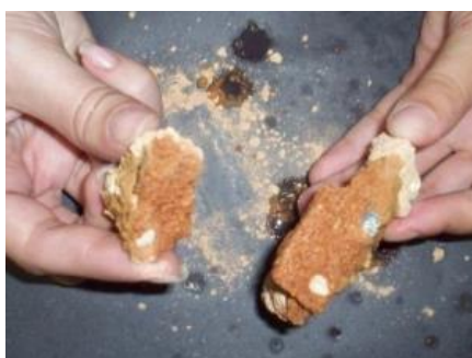
Figura 47 – ensaio de carbonatação em amostra de argamassa antiga
