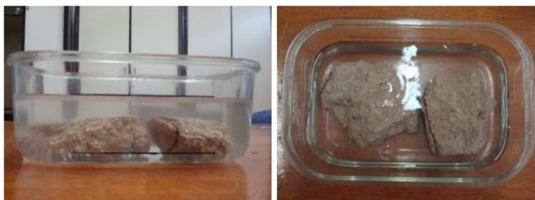
Figura 46 – amostras durante o ensaio de absorção total de água por imersão
