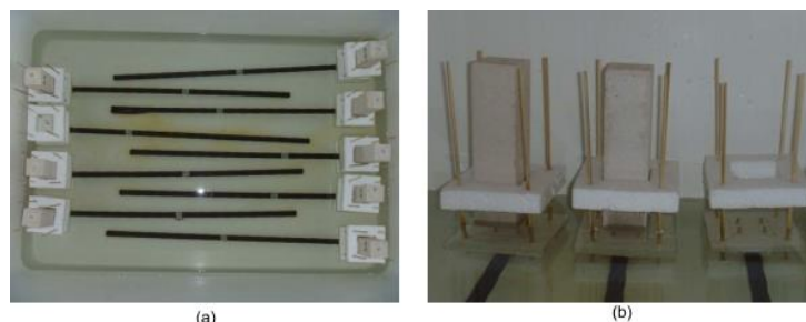
Figura 64 – ensaio de absorção de água por capilaridade: (a) vista geral e (b) suportes com e sem corpo de prova
