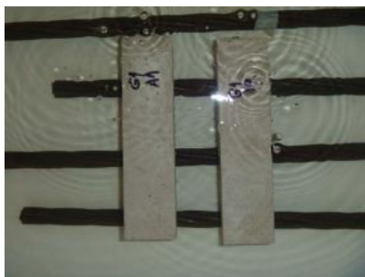
Figura 65 – corpos de prova imersos em água para realização do ensaio de absorção total por imersão
