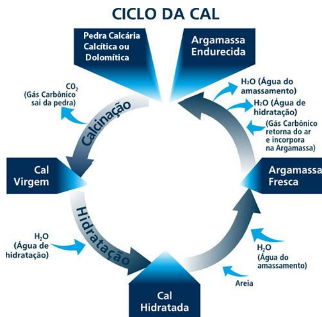
Figura 39 – ciclo da cal aérea na argamassa
