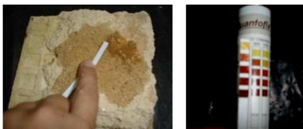
Figura 81 – ensaio de análise aos sais da argamassa aderida
