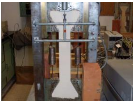
Figura 61 – aparelho usado no ensaio de susceptibilidade à fendilhação
