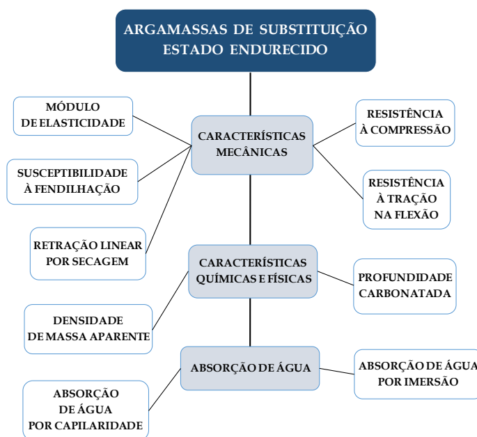
Figura 58 – organização dos ensaios das argamassas de substituição no estado endurecido
