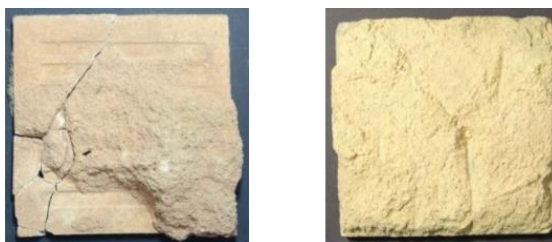
Figura 78 – argamassa aderida ao tardo de azulejo antigo
