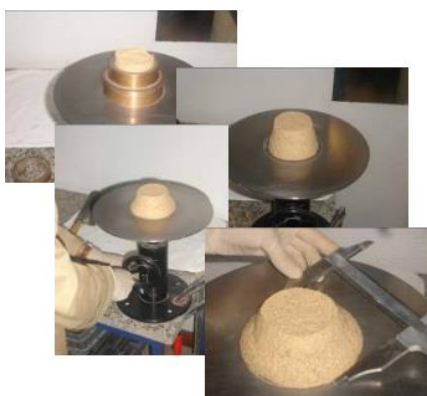
Figura 56 – ensaio de consistência por espalhamento
