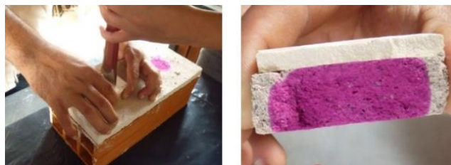
Figura 63 – ensaio de profundidade carbonatada em corpo de prova
