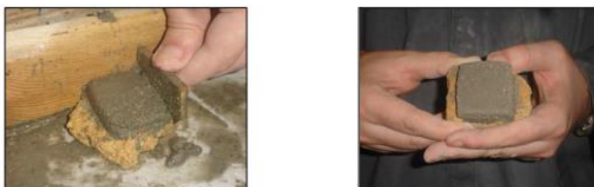
Figura 43 – preparo da amostra para o ensaio de resistência à compressão
