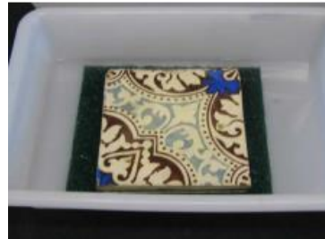
Figura 34 – recipiente com amostra apoiada em material geotêxtil e imersa em água
