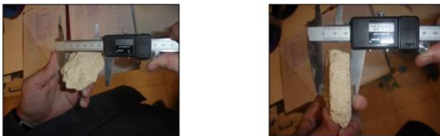
Figura 42 – determinação das dimensões das amostras de argamassas
