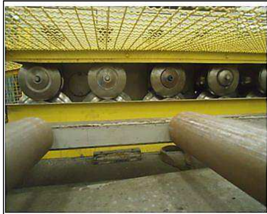
Figura 27 - Distribuição dos rolos conformadores
