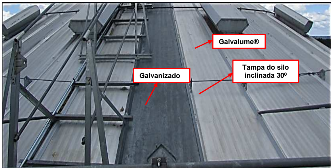
Figura 52 - Amostras expostas aço Galvanizado e Galvalume ®
