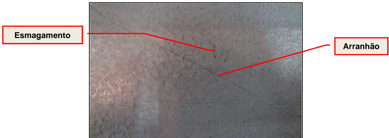
Figura 25 - Arranhões e fissuras
