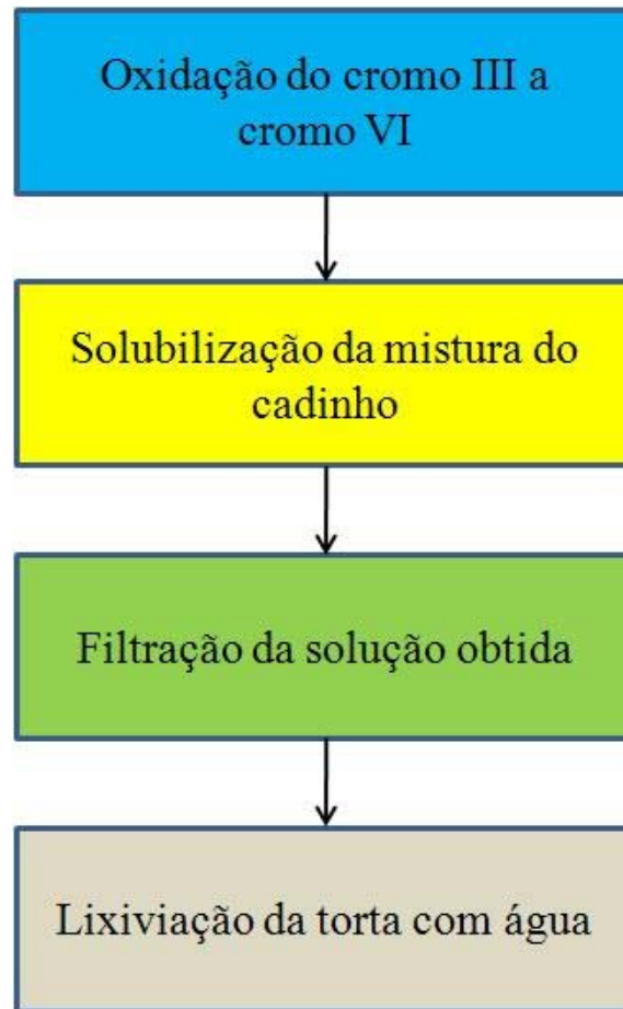
Figura 3.2: Etapas necessárias para obtenção do cromato de sódio
