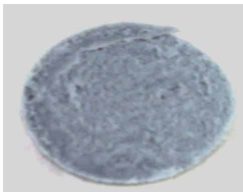
Figura 4.2: Tablete de pó de pele após curtimento e filtração
