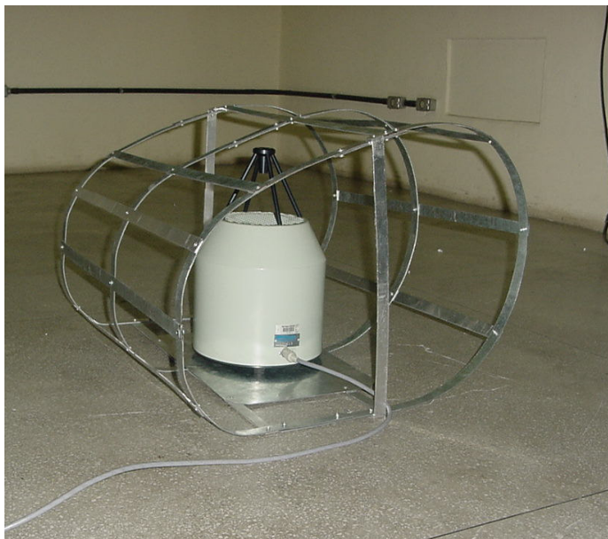
Figura 12.2 – Estrutura com dimensões e formato similar ao compressor parafuso
