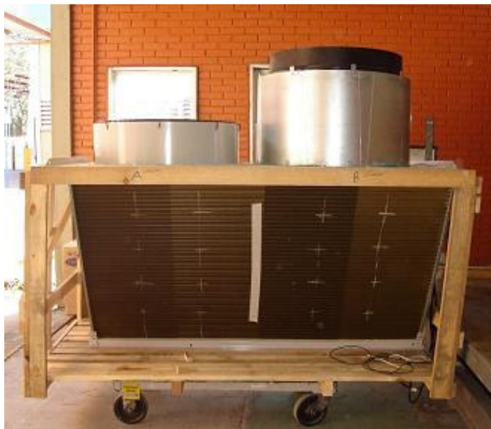
Figura 9.7 – Duto na tomada de ar do ventilador
