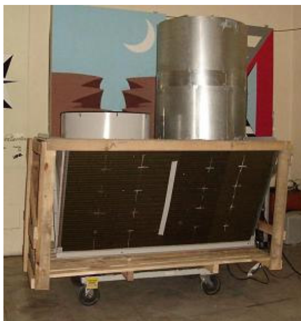
Figura 9.8 – Aspecto externo do novo conceito de atenuador de ruído
