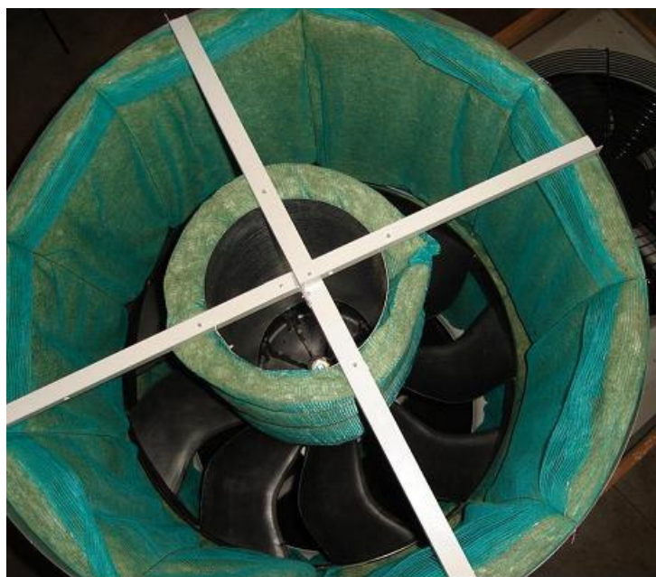
Figura 9.9 – Cilindros concêntricos nos dois dutos envoltos por lã de rocha
