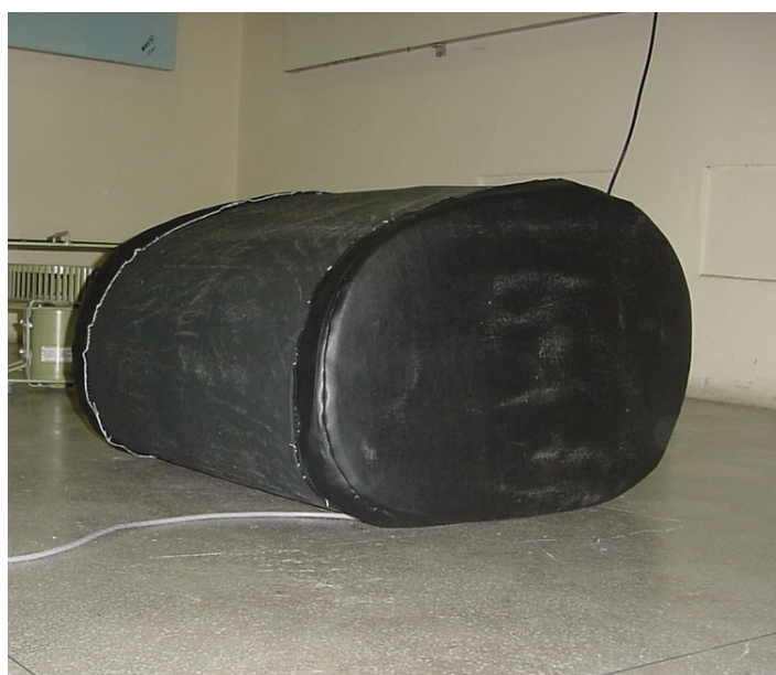
Figura 12.3 – Protótipo de jaqueta acústica
