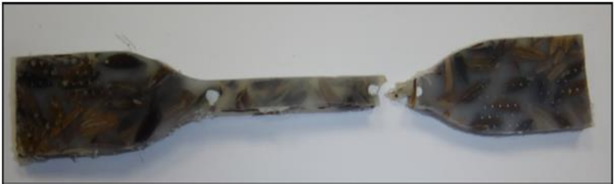
Figura 61 - Corpos de prova com marcações para ensaio de alongamento das amostras avaliadas
