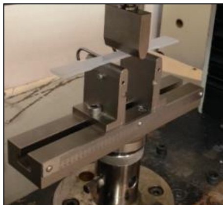
Figura 29 - Dinamômetro Instron usado para o ensaio de flexão
