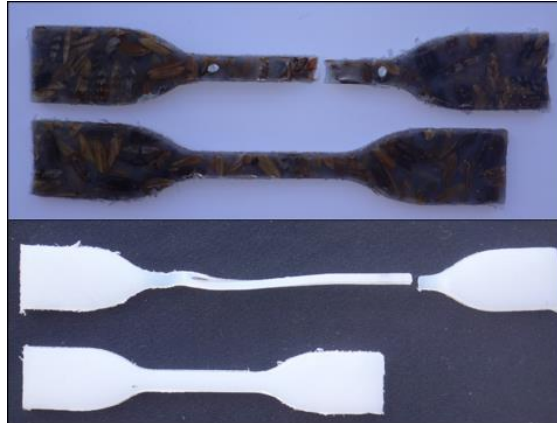
Figura 63 - Comparativo de deformação entre PEUAPM virgem e das amostras avaliadas
