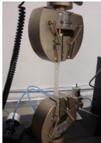
Figura 31 - Dinamômetro Instron usado para ensaio de resistencia
