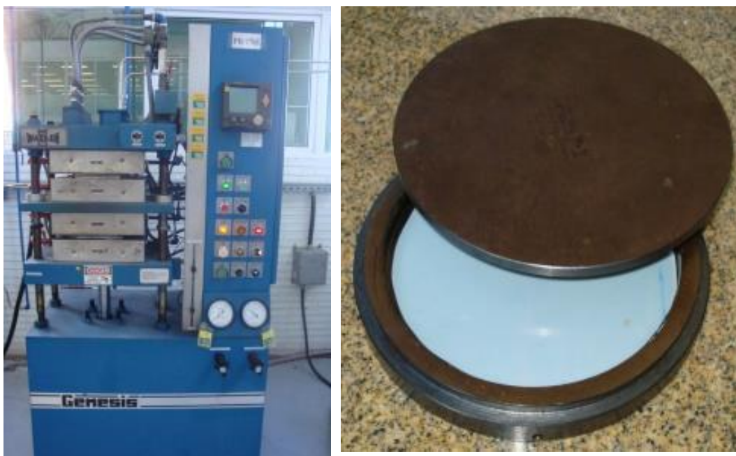
Figura 24 - Prensa térmica (a) e molde positivo (b)
