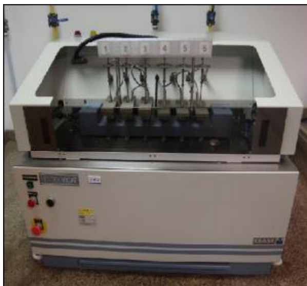
Figura 32 - Equipamento usado para ensaio de HDT
