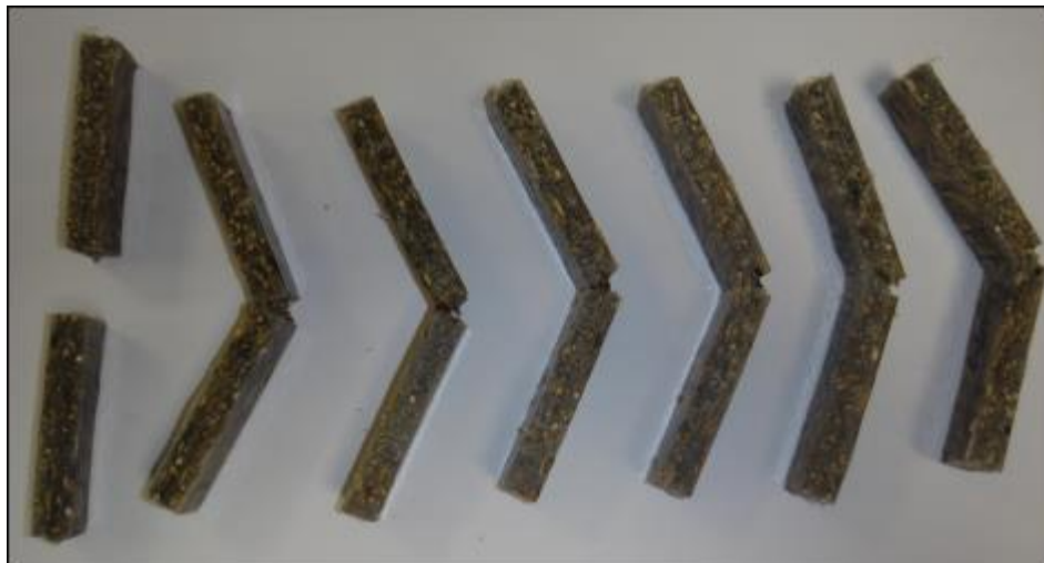
Figura 53 - Corpos de prova 60/40 - Ensaio Charpy
