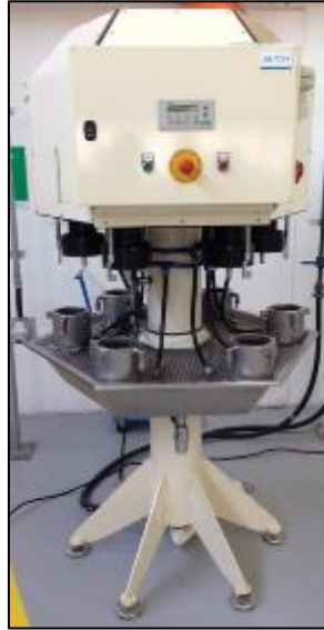
Figura 30 - Equipamento OKS-5 para ensaio de resistencia a abrasão.
