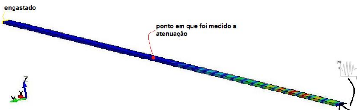
Figura 14. Simulação Numérica, ilustração da onda viajando sobre a haste em termos de tensões de Von Mises.
