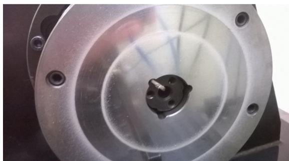
Figura 5.5 – Disco de ferro fundido cinzento após realização do ensaio de limite PV na amostra ABS2.
