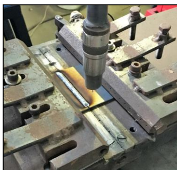
Figura 4.2 - Ilustração de restrição em juntas para o processo de soldagem.
