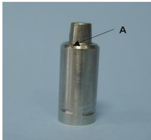
A – canaleta de secção triangular.
