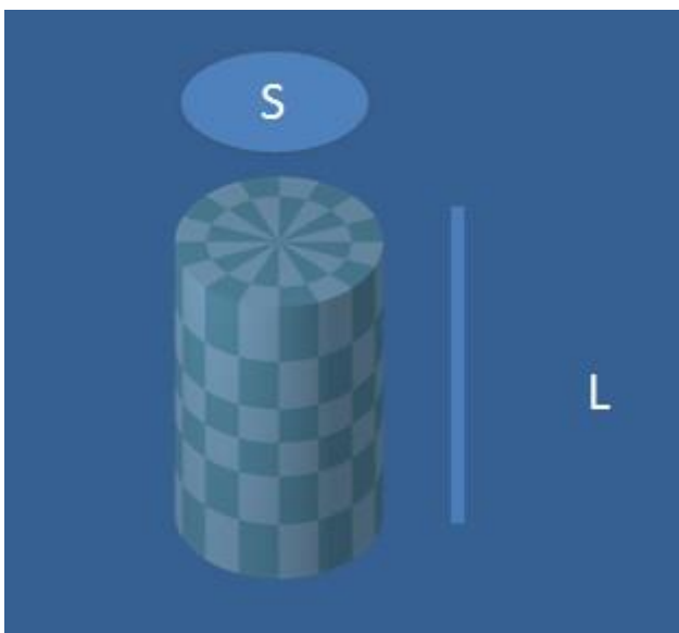
Figura 11- Representação gráfica do modelo teórico para a passagem de eletricidade por um meio.
