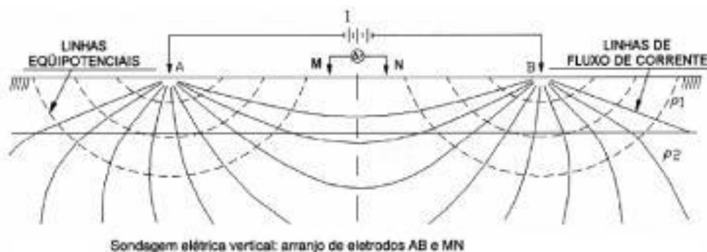
Figura 12 - Arranjo dos eletrodos do tipo Schlumberger da Sondagem Elétrica Vertical.
