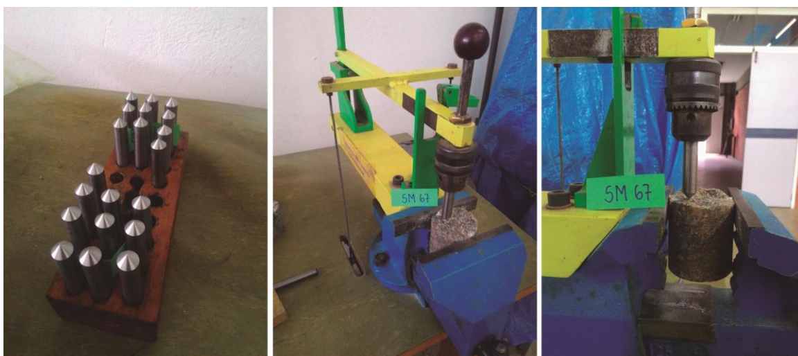
Imagem 6 – Ponteiros utilizados e amostra sendo ensaiada.
