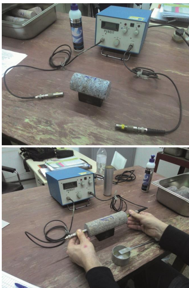
Imagem 3 – Realização do ensaio com equipamento de Ultrassom
