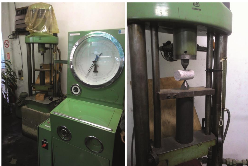
Imagem 4 - Prensa hidráulica utilizada para realizar o ensaio. Em detalhe corpo de prova sendo submetido a tensão.
