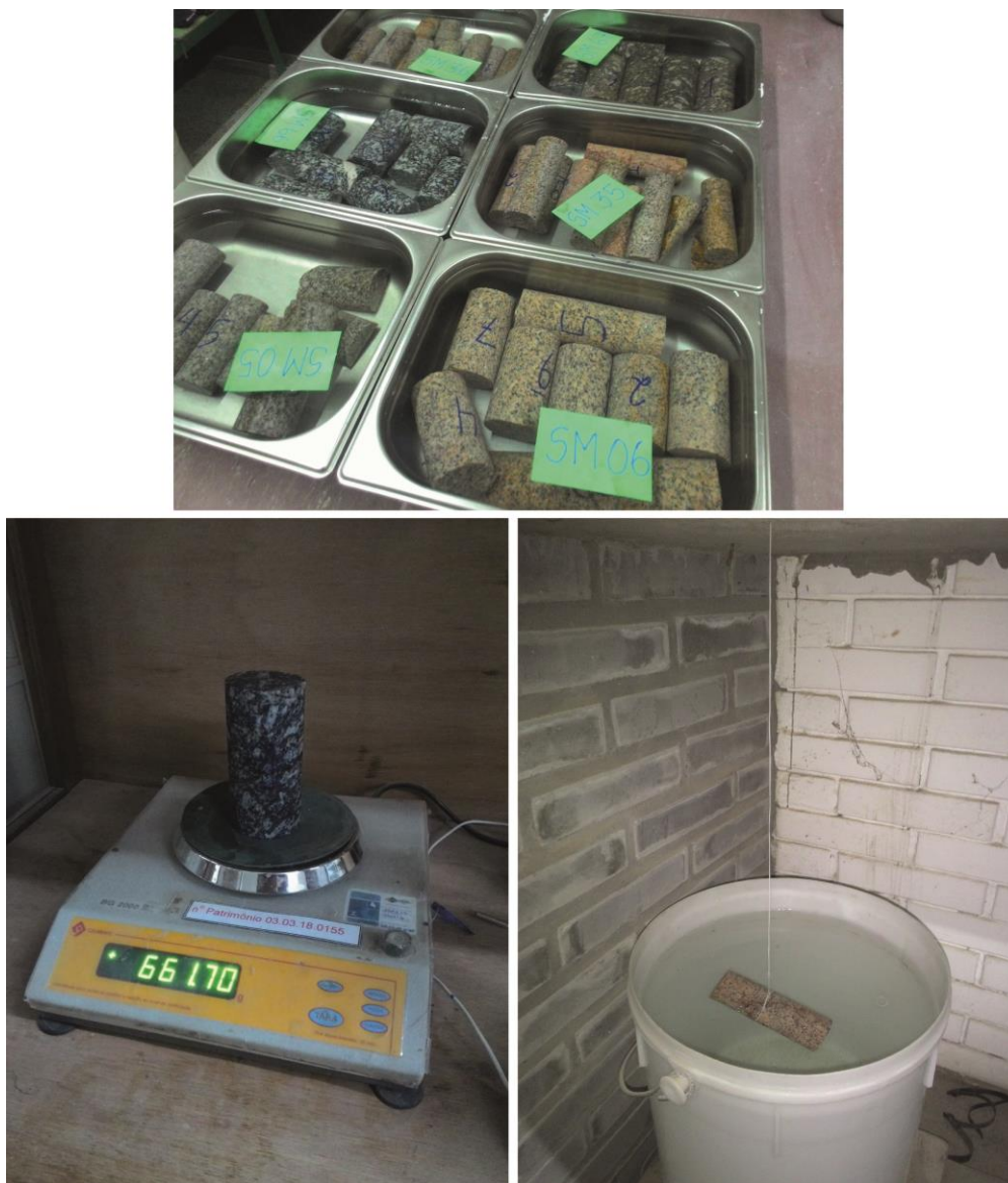
Imagem 2 – Diferentes etapas do ensaio de determinação de índices físicos
