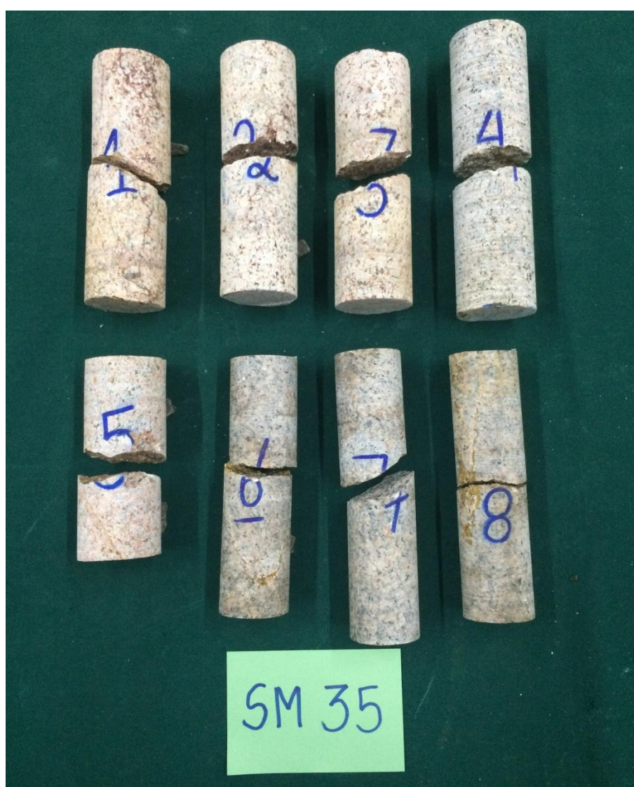
Imagem 5 – Corpos de prova após serem submetidos ao ensaio de carga pontual.
