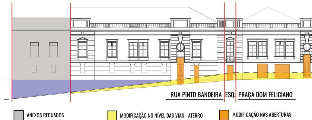
Figura 47 - Fachada com as alterações de aberturas identificadas
