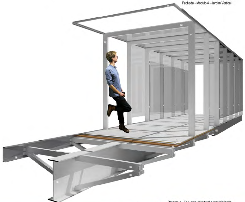
Passarela - Esquema estrutural e materialidade
