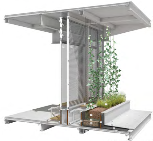
Fachada - Modulo 4 - Jardim Vertical
