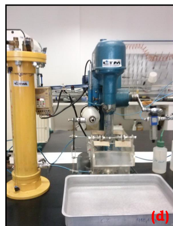
Figura 1. (a) Flotação STD; (b) Aspecto visual do óleo diesel/água antes e após sua emulsificação (EXT); (c) Condicionamento turbulento (CAI); (d) Sistema geração e injeção de MB/NB.
