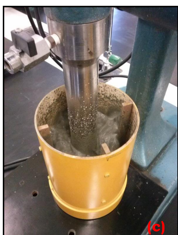
Figura 1. (a) Flotação STD; (b) Aspecto visual do óleo diesel/água antes e após sua emulsificação (EXT); (c) Condicionamento turbulento (CAI); (d) Sistema geração e injeção de MB/NB.
