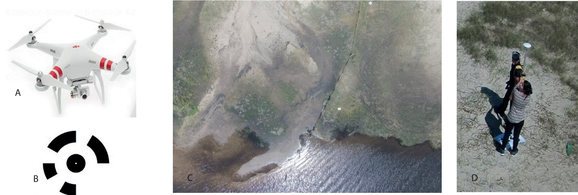
Figura 2: (A) Ilustração do equipamento usado na aquisição das imagens; (B) Modelo do target utilizado para marcação; (C) Distribuição dos targets na párea de estudo; (D) Medições com GNSS.
