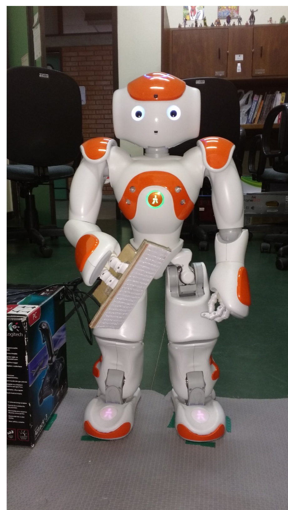
Figura 2: Robô NAO com ferramenta auxiliar
