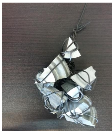
Figura 3.3 Amostras amarradas por um fio de aço para serem submetidas à têmpera.
