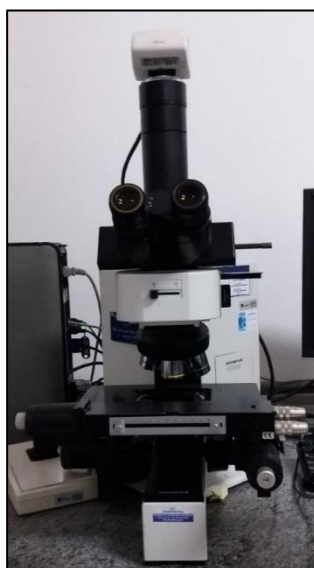
Figura 3.15 Microscópio óptico utilizado para observação da microestrutura de amostras de aço.
