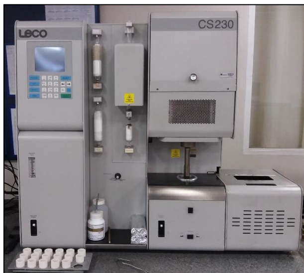
Figura 3.17 Medidor simultâneo de Carbono e Enxofre LECO CS 230, utilizado para análise do teor de Carbono e Enxofre do aço SAE 52100.
