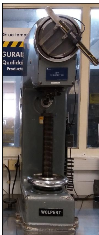
Figura 3.18 Durômetro Wolpert Dia Testor 2N, utilizado no ensaio de dureza Brinell do aço SAE 52100.
