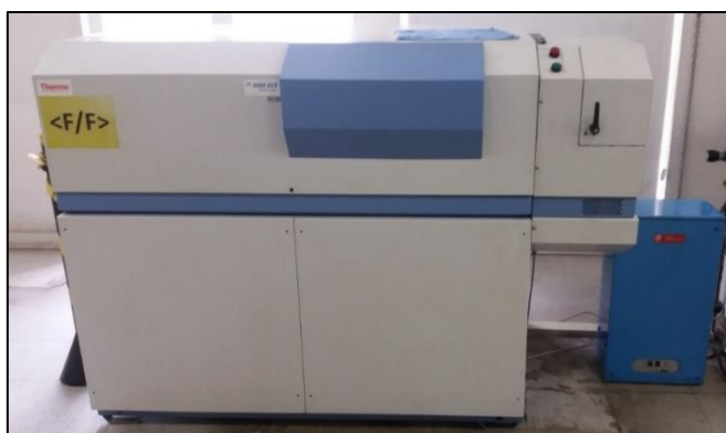
Figura 3.16 Espectrômetro de Emissão Ótica ARL 4460, utilizado para análise da composição química do aço SAE 52100.
