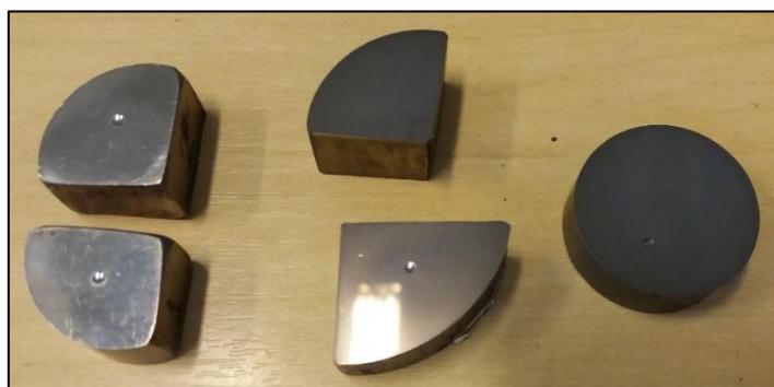
Figura 3.22 Corpos de prova preparados para o ensaio de dureza Brinell, já realizada a impressão em alguns deles.
