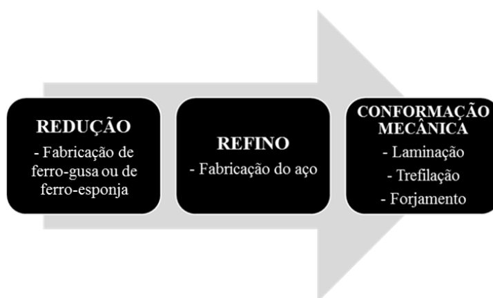
Figura 2.1 Principais etapas do processo siderúrgico: Redução, Refino e Conformação Mecânica.
