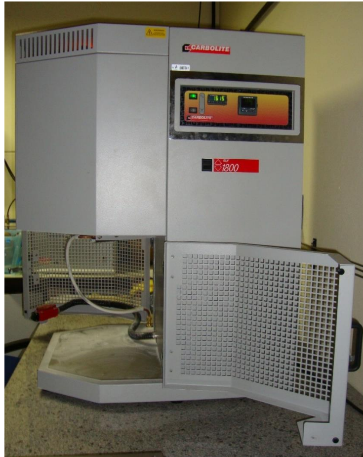
Figura 6. Forno Carbolite® BFL 18/3, LAPMA. A entrada da amostra se dá através de um elevador na porção inferior da cabeça do forno. Isso minimiza a perda de calor do forno durante o manuseio da amostra.
