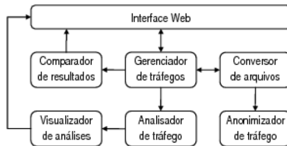
Figura 1. Arquitetura de uma ferramenta para medições de tráfego SNMP
