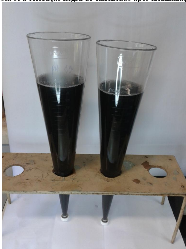
Figura 15 Imagem de Cones de Imhoff com efluente após processo de acidificação e elevação a pH neutro. Nota-se a coloração negra do clarificado após alcalinização
