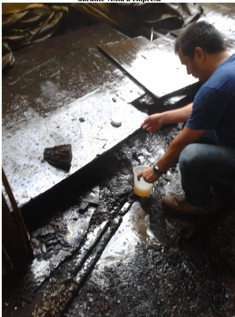
Figura 3 Coleta manual de efluente realizada no canal de escoamento de efluente em fevereiro de 2016 durante visita à empresa
