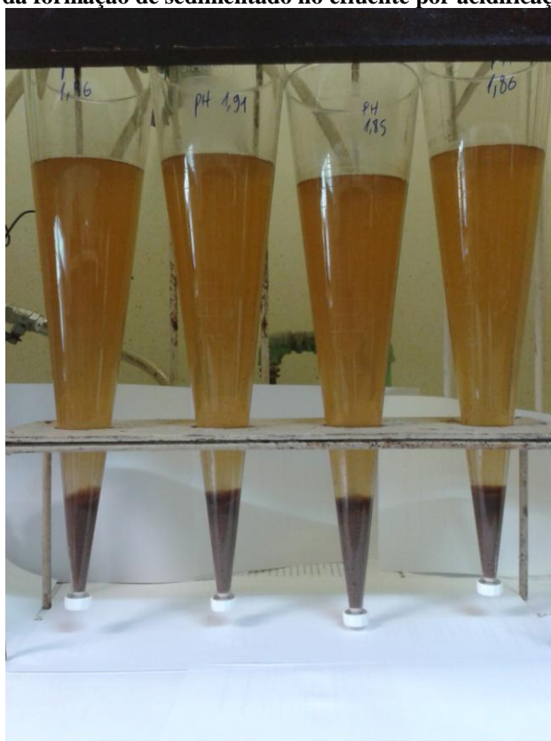
Figura 13 Imagem da formação de sedimentado no efluente por acidificação a pH abaixo de 2
