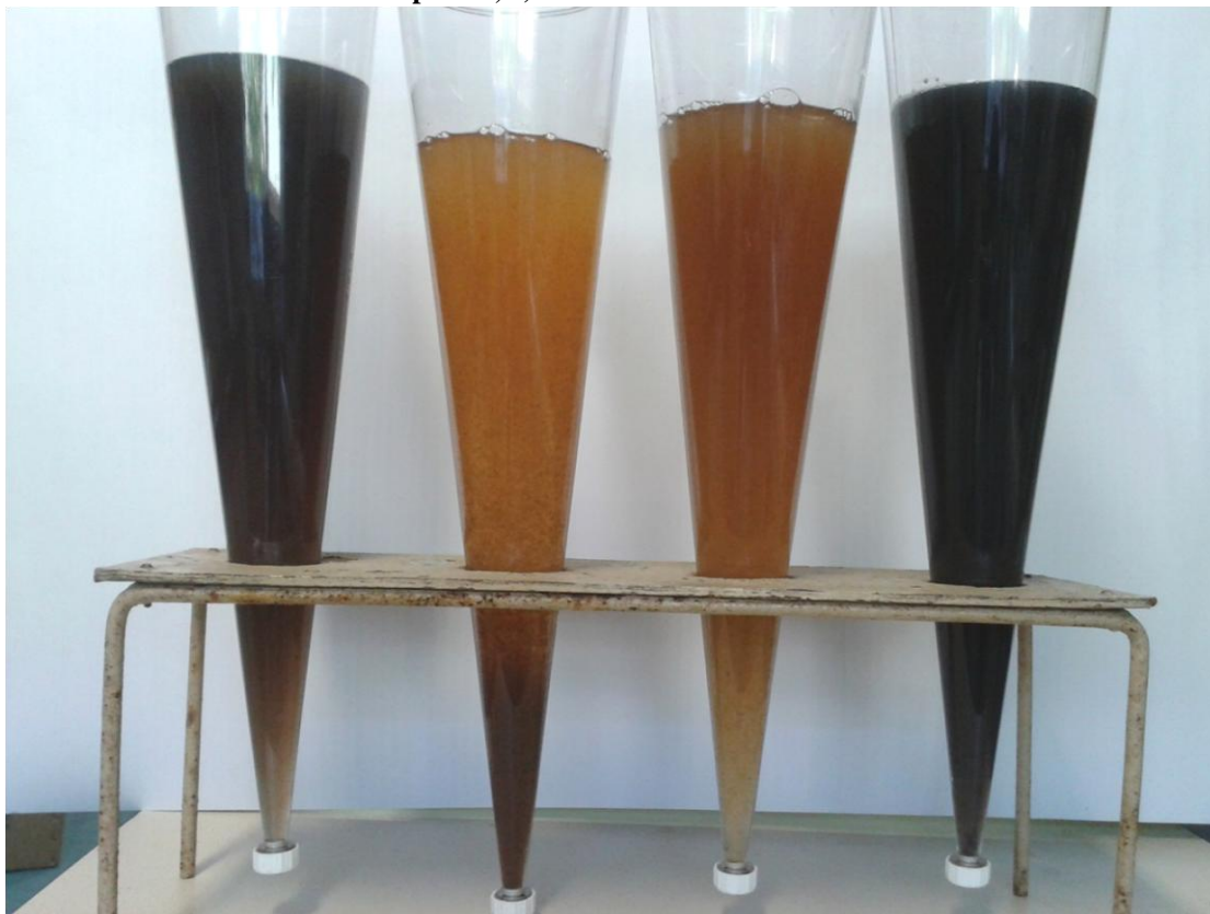
Figura 16 Diversos estágios do efluente durante o processo: (da esq. para dir.) 1) Efluente Bruto, 2) Efluente acidificado com flocos formando sedimentado, 3) Efluente recém acidificado com flocos ainda suspensos, 4) Clarificado alcalinizado.
