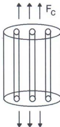
Figura 2: Compósito com fibras alinhadas submetidas a uma força F_c .
