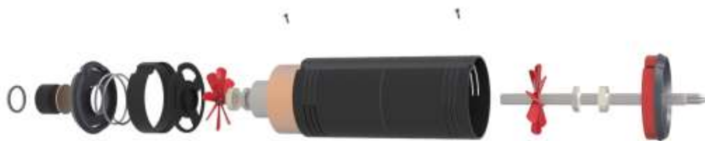
Figura 64 - Vista explodida do conjunto do motor. Fonte: Autor.
