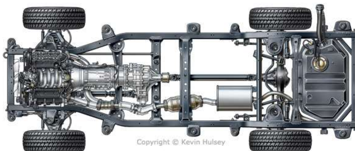
Figura 3 – Chassi que pode ser aplicado a diferentes carros. Fonte: Carro sem segredo. 5
