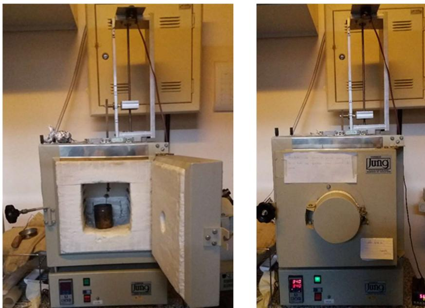
Figura 12 – Imagem do forno, do recipiente com o sal fundido de prata e do sistema de imersão motorizado com porta-amostras utilizado no procedimento de troca iônica para a fabricação dos guias de onda.
