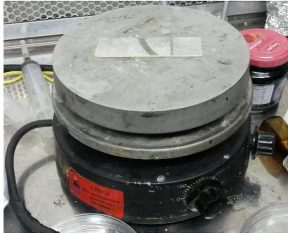
Figura 21 – Prato quente utilizado para o recozimento das amostras.
