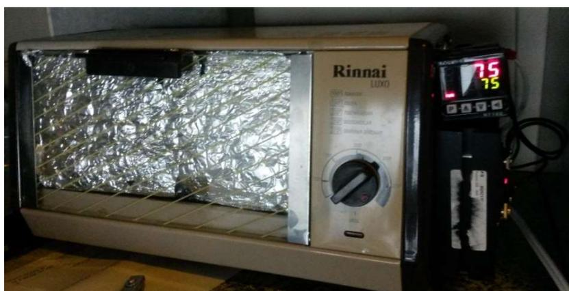
Figura 16 – Forno utilizado para realizar os recozimentos.
