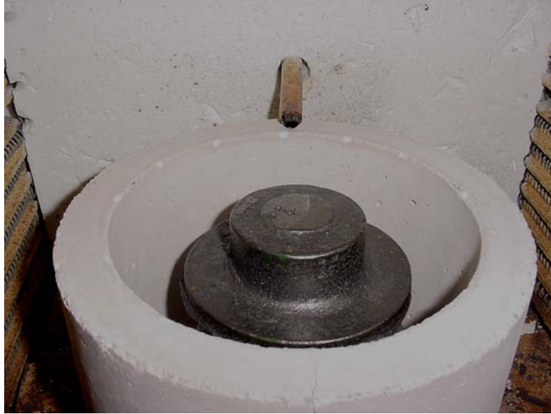
Figura 26 – Vista Frontal do Forno com Outras Peças Dentro da Bobina (solenóide) de Indução Fonte: LAMEF – LAB. METALURGIA FÍSICA/UFRGS.
