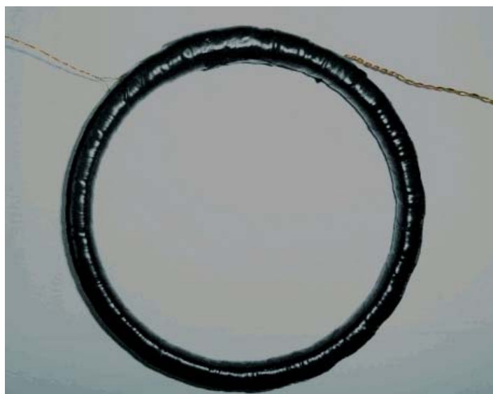
Figura 21 – Anel em FoFo Nodular Bobinado Preparado para o Teste de Saturação Magnética Fonte: LAM – LAB. MAGNETISMO/UFRGS.
