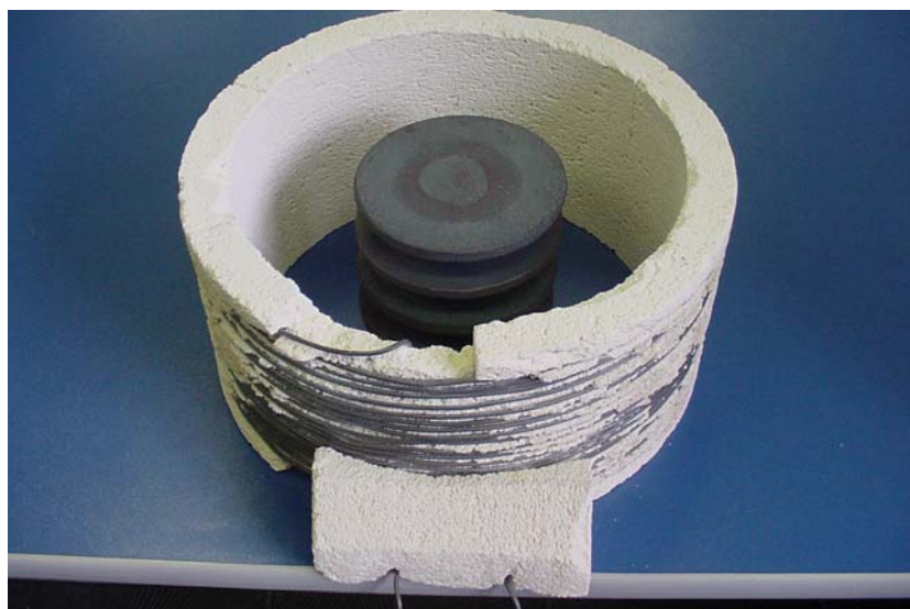
Figura 25 – (03 peças) Montadas Dentro da Bobina (solenóide) Especialmente Construída para este Trabalho Fonte: LAMEF – LAB. METALURGIA FÍSICA/UFRGS.
