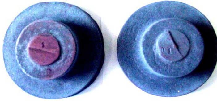
Figura 42 – Peça Polar Nova L1 Ferro Fundido Nodular Fonte: Foto realizada pelo autor no LdSM/UFRGS.
