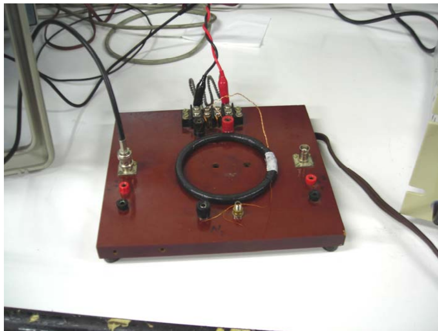
Figura 23 – Anel bobinado Extraído da Peça Fundida na Bancada Submetido a Saturação Magnética Fonte: LAM – LAB. MAGNETISMO/UFRGS.
