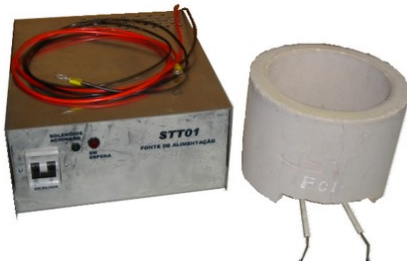
Figura 30 – Fonte de Alimentação e a Solenóide de Indução Fonte: LAM – LAB. MAGNETISMO/UFRGS.
