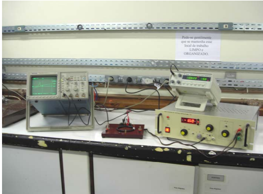
Figura 22 – Ensaio de Saturação Magnética no LAM (Laboratório de Magnetismo da UFRGS) Fonte: LAM – LAB. MAGNETISMO/UFRGS.
