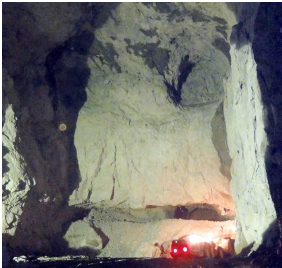
Figura 91 - Foto durante extração de uma das câmaras com ângulo do hangingwall subvertical, observa-se a LHD em operação por controle remoto
