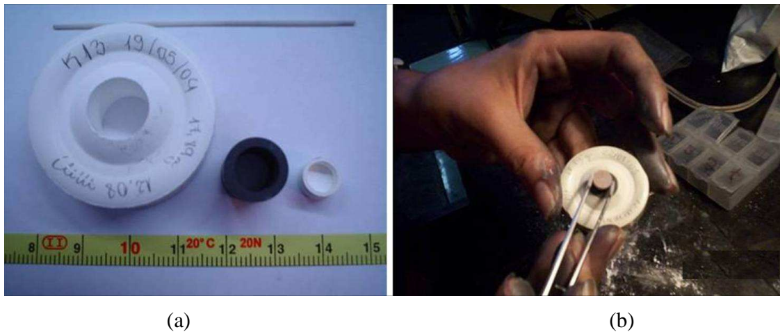
Figura 4-4: (a) Fotografia mostrando (da esquerda para a direita): uma gaxeta, um forno de grafite e uma câmara de h-BN e; (b) Montagem da configuração no instante em que um dos discos de pirofilite é inserido no forno de grafite.
