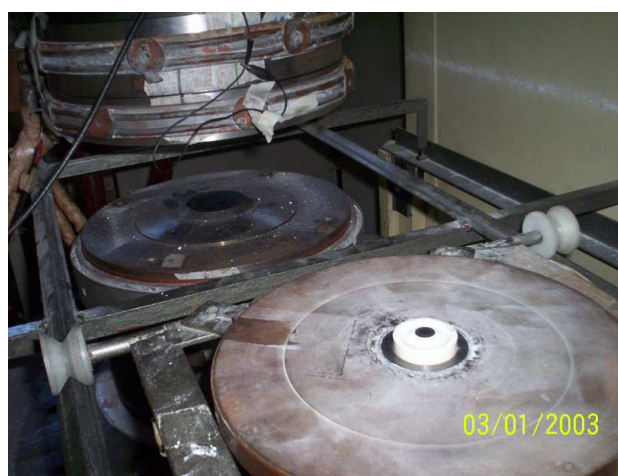
Figura 4-2: Fotografia de uma das faces da câmara com a amostra já posicionada (em primeiro plano) e da prensa (ao fundo) utilizada nos processamentos.
