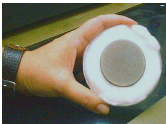
Figura 2-6: Filme de diamante CVD auto-sustentado produzido no LAPMA.
