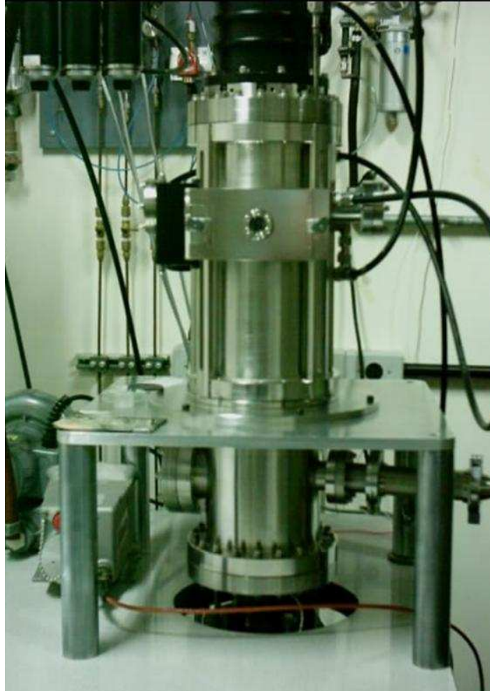
Figura 4-1: Reator CVD com plasma ativado por microondas onde foram realizadas as deposições dos filmes de diamante policristalinos utilizados neste trabalho.
