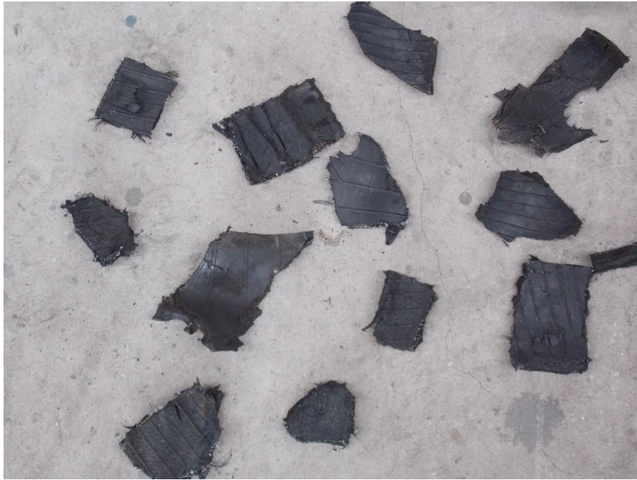
Figura 7 – Tamanho aproximado de pneus como meio suporte
