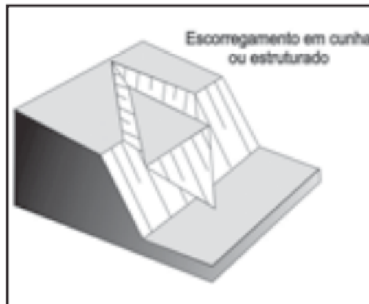
Figura 12 – Escorregamento em Cunha
